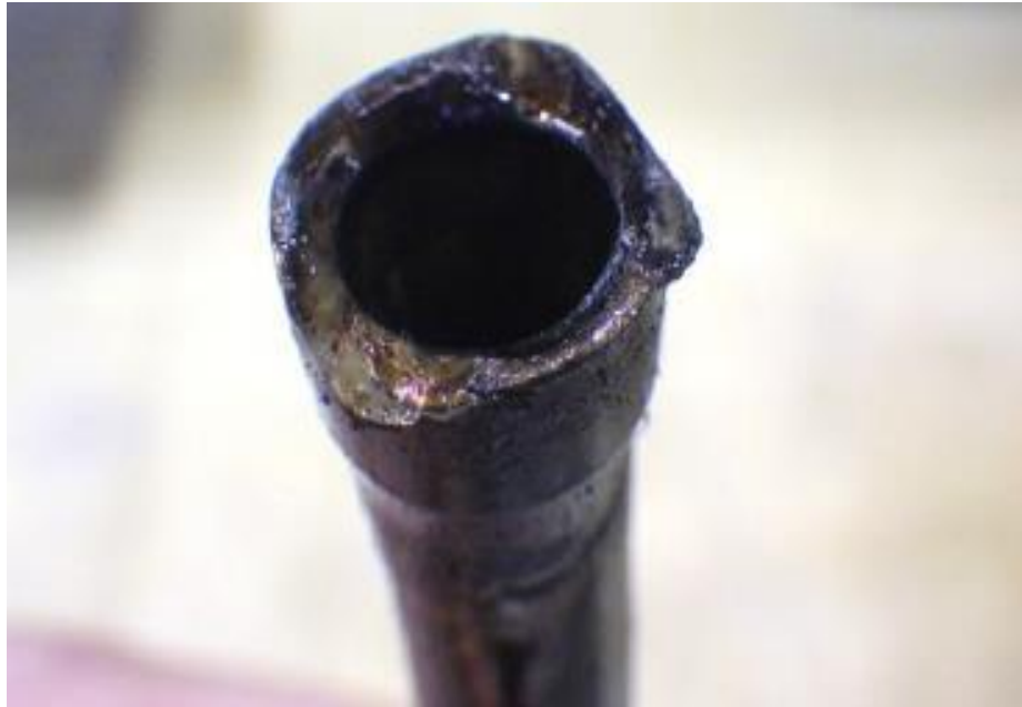
Rys. 16 Widok uszkodzonej rurki doprowadzającej olej do łożysk [źródło: P&WC]
