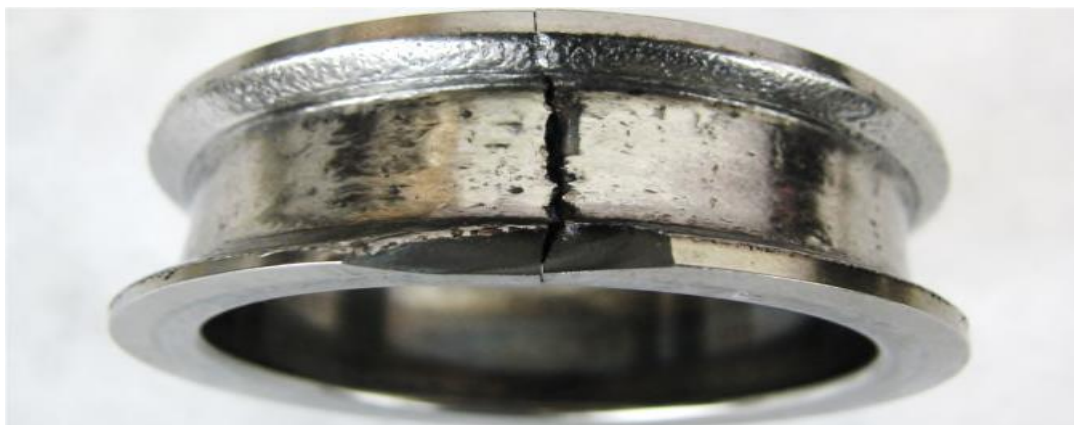
Rys. 20 Pęknięcie na pierścieniu wewnętrznym łożyska [źródło: P&WC]
