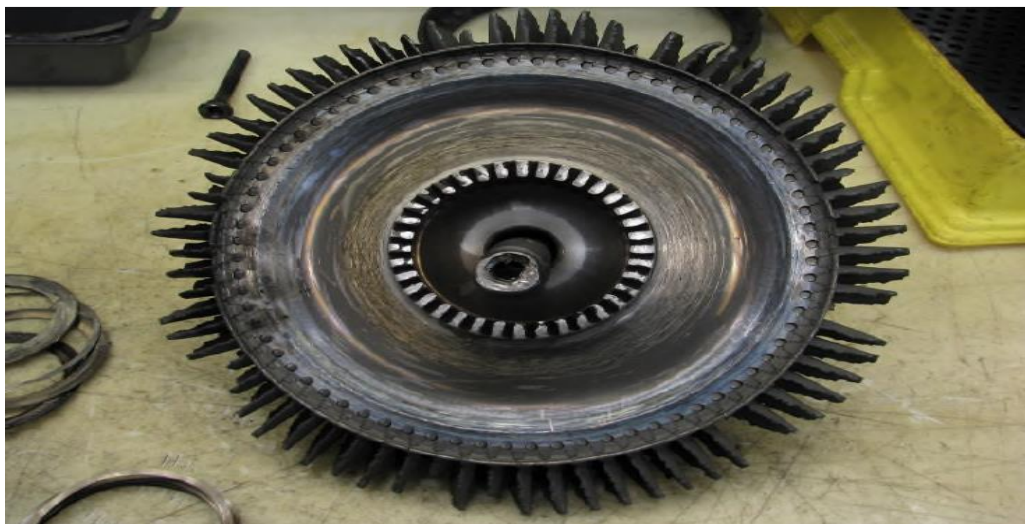
Rys. 15 Widok uszkodzonych łopatek oraz ukręconego wału turbiny PT2 [źródło: P&WC]
