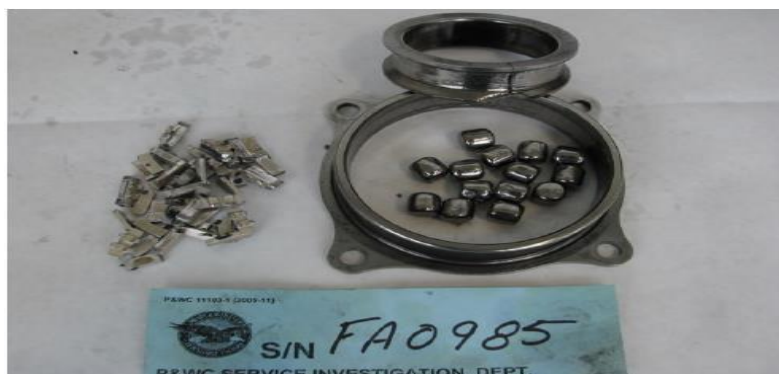
Rys. 10 Fragmenty uszkodzonego łożyska nr 8 [źródło: P&WC]
