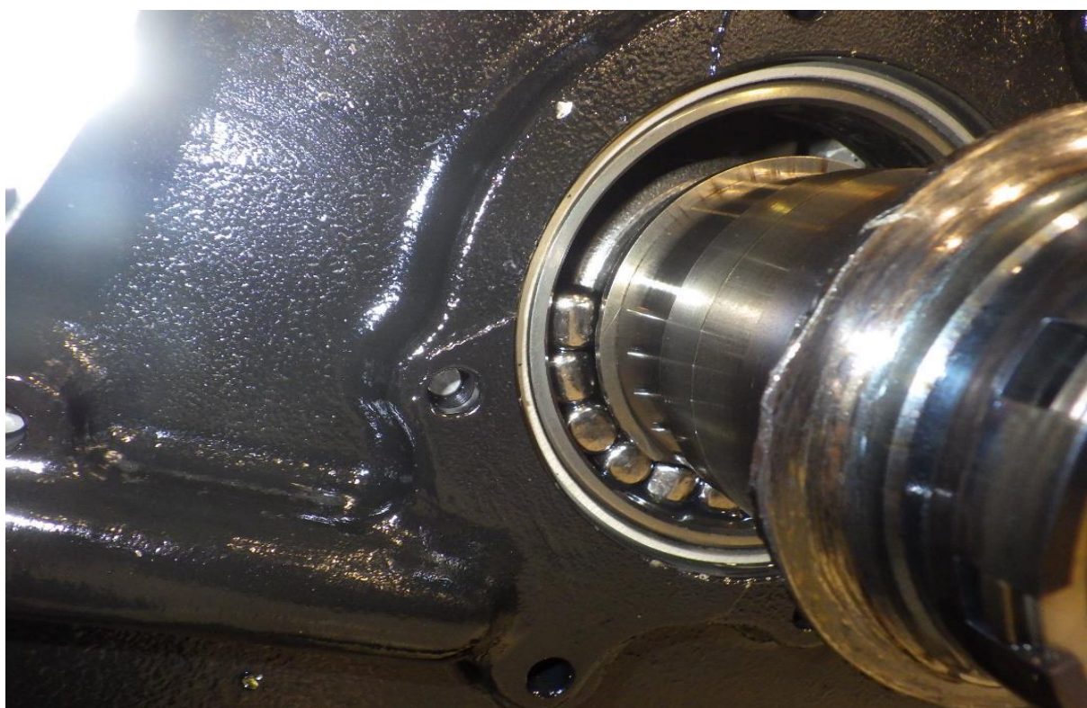
Rys. 11 Widok łożyska nr 8 od strony modułu turbo-wirnikowego. Na pierwszym planie widoczny pęknięty kołnierz sprzęgła membranowego [źródło: P&WC]
