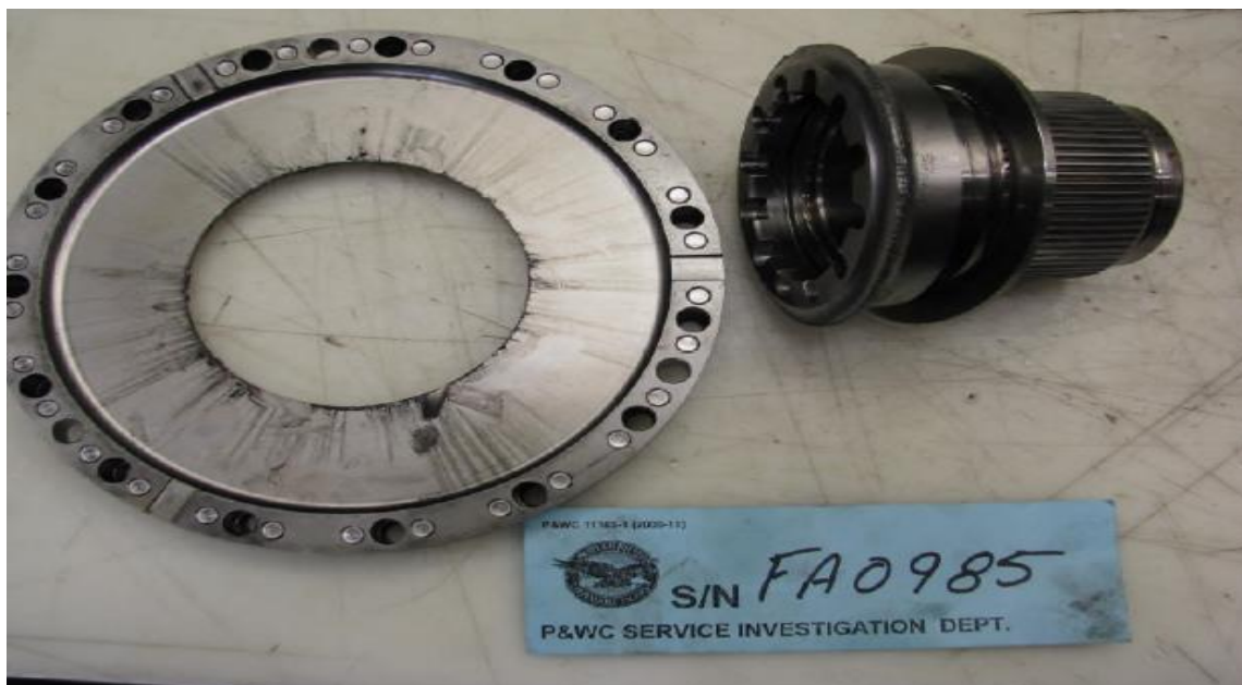
Rys. 13 Końcówka wału PT ze ściętym kołnierzem [źródło: P&WC]
