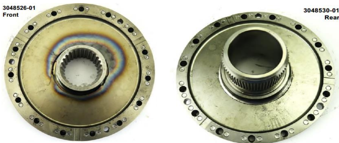
Rys. 19 Urwane wałki sprzęgła membranowego pokazane w położeniu pierwotnym [źródło: P&WC]
