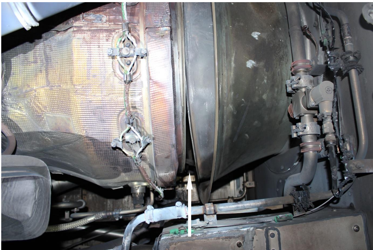
Rys. 7 Widoczne uszkodzenia i ślady pożaru z lewej strony silnika nr 2. [źródło: PKBWL]
