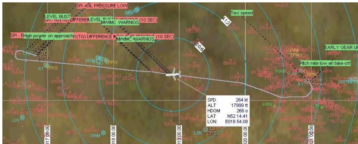
Rys. 1 Moment pojawienia się pierwszych symptomów nieprawidłowej pracy silnika (12:22) [źródło: PLL LOT]
