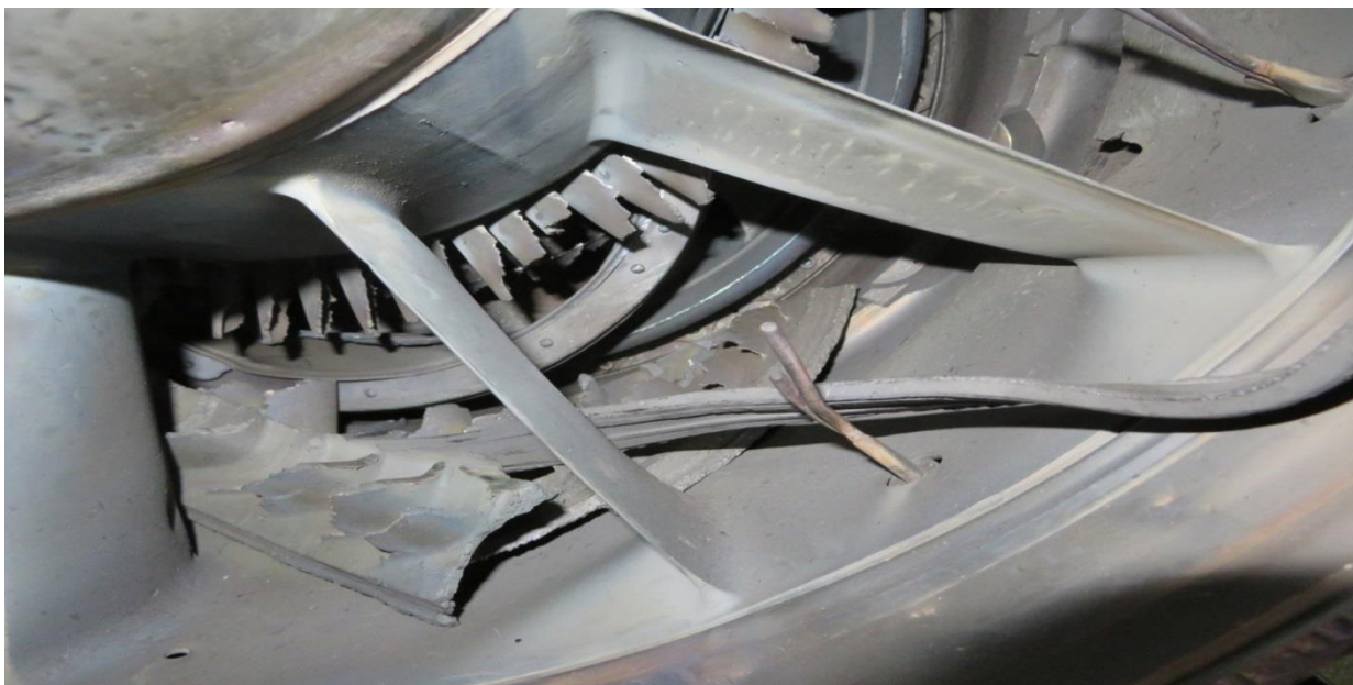
Rys. 8 Widok uszkodzeń silnika od strony turbiny napędowej [źródło: PKBWL]
