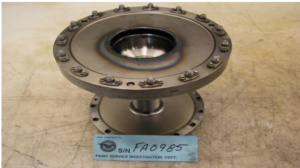
Rys. 12 Sprzęgło membranowe. Widok od strony RGB [źródło: P&WC]
