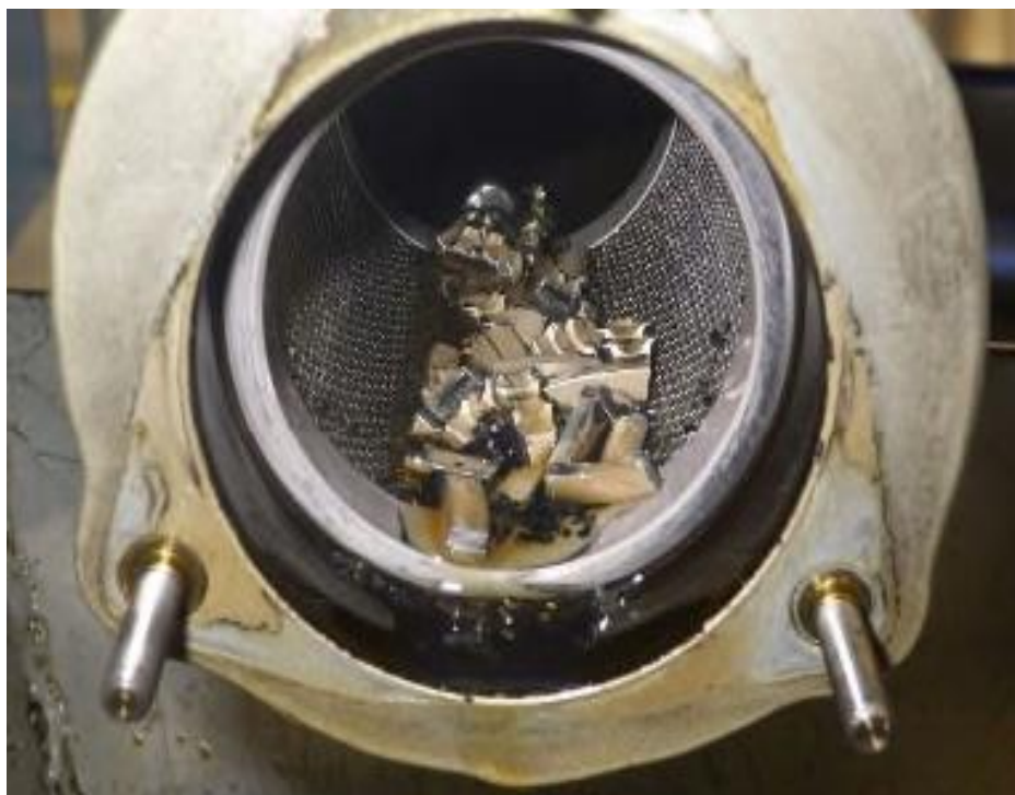
Rys. 18 Opiłki i elementy metalowe w filtrze głównym RGB [źródło: P&WC]
