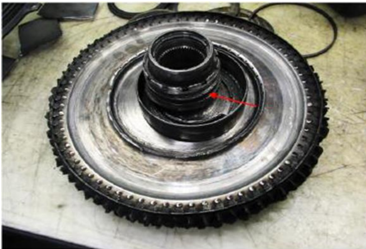
Rys. 14 Widok zniszczonych u podstawy wszystkich łopatek turbiny PT1 [źródło: P&WC]
