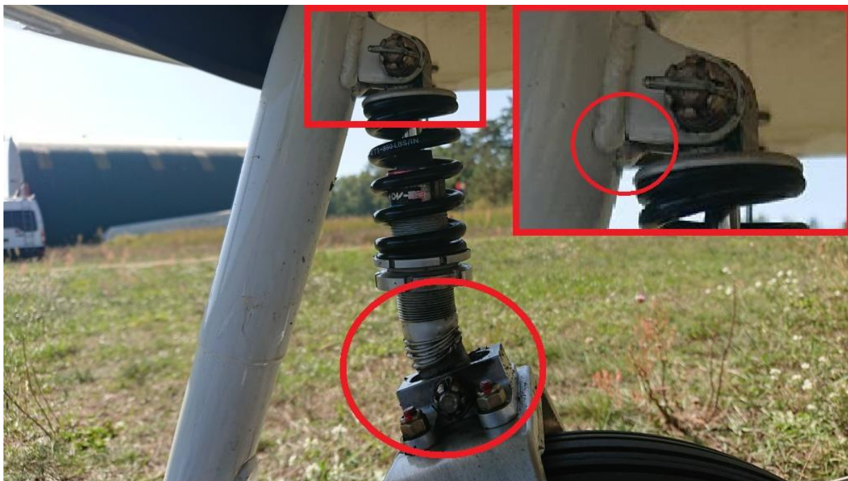
Rys. Uszkodzenia przedniej goleni podwozia samolotu [źródło: pilot samolotu]
