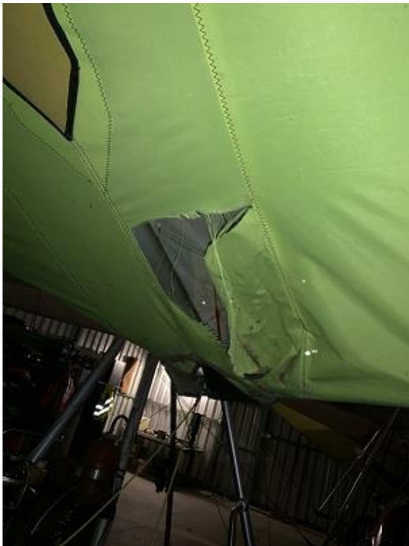
Rys. nr 3- uszkodzone poszycie skrzydła [ źródło właściciel]
