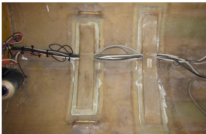
Rys. 3. Wylaminowane wzmocnienia skorupy kadłuba [źródło: AZL]
