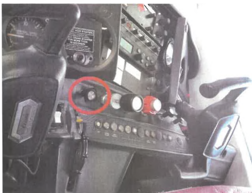
Rys. 10. Tablica przyrządów samolotu po wypadku. Widoczny wyłączony podgrzew gaźnika. [źródło; PKBWL]
