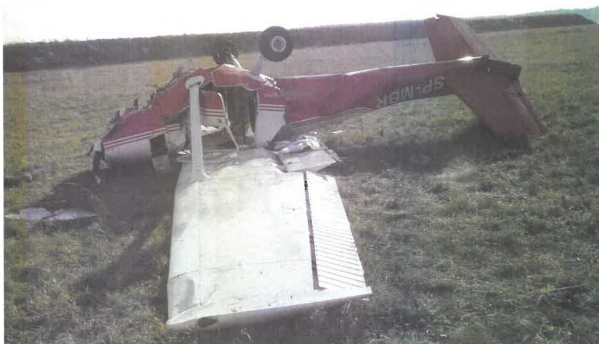
Rys. 7. Widok na samolot po zdarzeniu. Widoczne złamanie kadłuba za kabiną i inne uszkodzenia samolotu [źródło: PKBWL].
