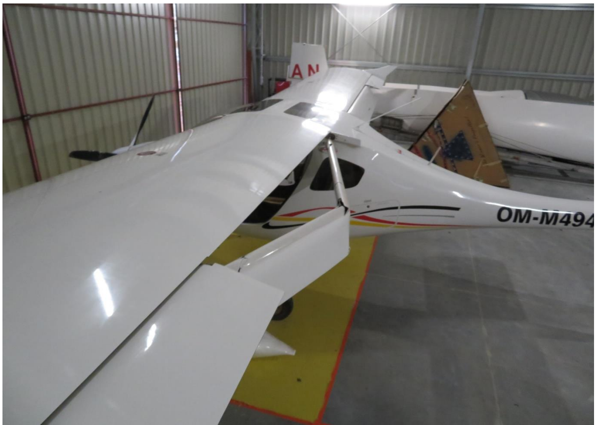
Rys. 3. Uszkodzona kłapa lewego skrzydła [źródło PKBWL]
