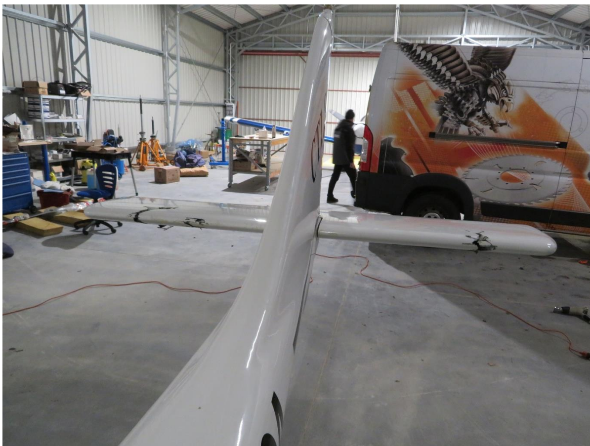
Rys. 5. Uszkodzony statecznik poziomy [źródło PKBWL]
