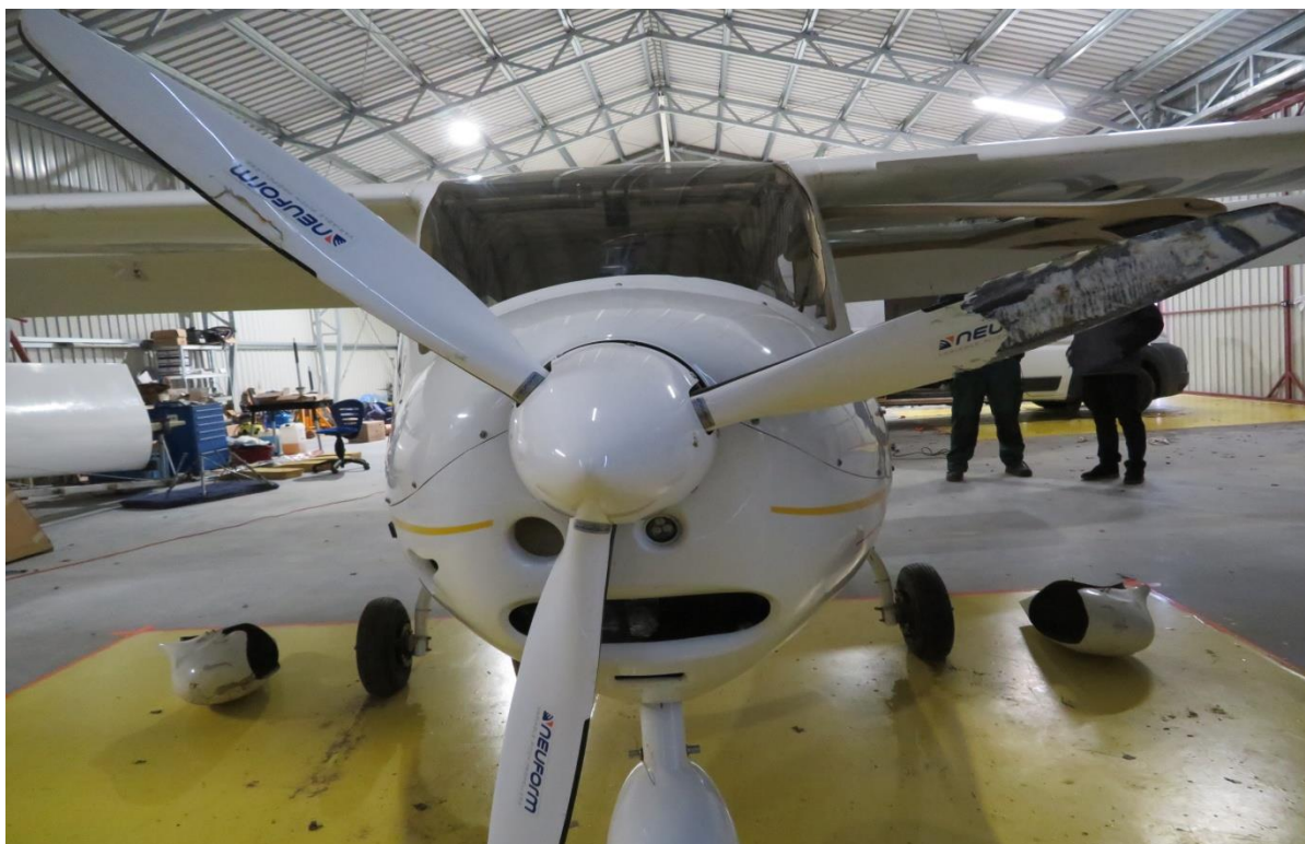
Rys. 4. Uszkodzone śmigło samolotu [źródło PKBWL]
