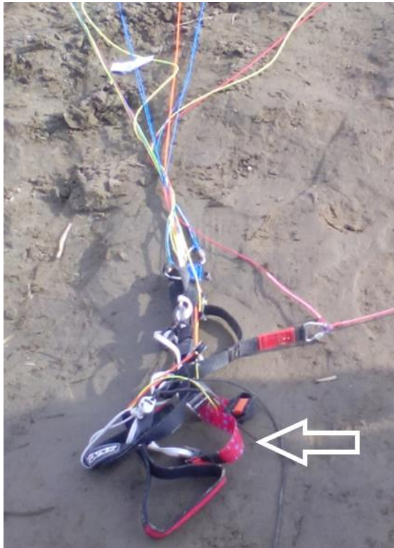
Rys. 3. Strzałka wskazuje odpuszczoną taśmę lewego trymera [źródło: PKBWL].
