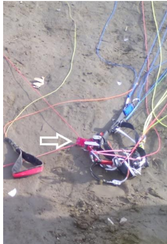
Rys. 4. Strzałka wskazuje ściągniętą taśmę prawego trymera [źródło: PKBWL].
