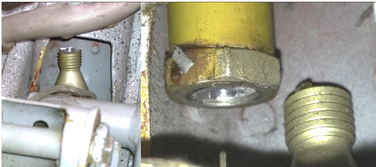
1, 2 – Odłamana widelkowa dolna końcówka popychacza P/N:CE155090 w słupku wręgi nr 2 kadłuba oraz dolne zakończenie popychacza z odłamanym fragmentem końcówki widelkowej i gwintowane zakończenie odłamanej końcówki widelkowej P/N:X1148.
