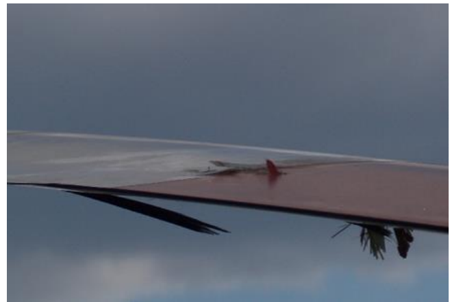
Rys. 2. Zdjęcie uszkodzonej łopaty wirnika [źródło: PKBWL]
