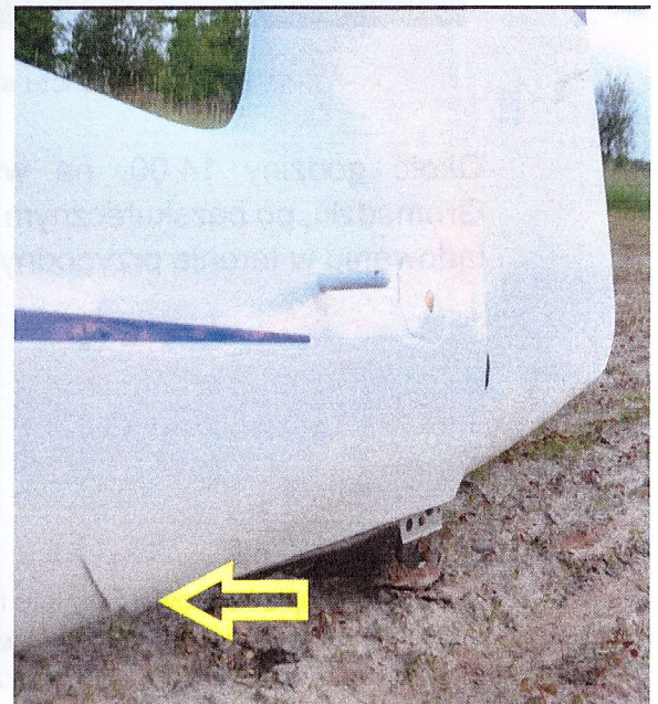
Rys. 3. Pęknięcie poszycia kadłuba w części ogonowej [źródło: użytkownik]
