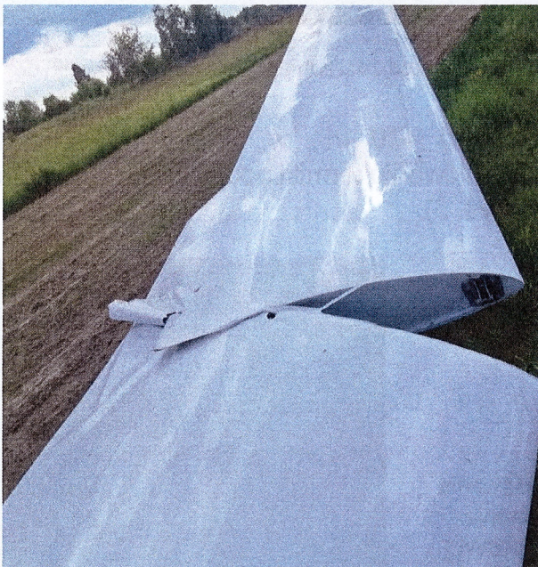
Rys. 2. Uszkodzony centroptłat i wyłamana końcówka lewego skrzydła [źródło: użytkownik]
