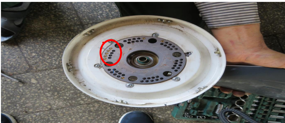
Rys. 9. Pięć ciężarków wkręconych na tarczy po stronie urwanej łopaty [źródło: PKBWL]
