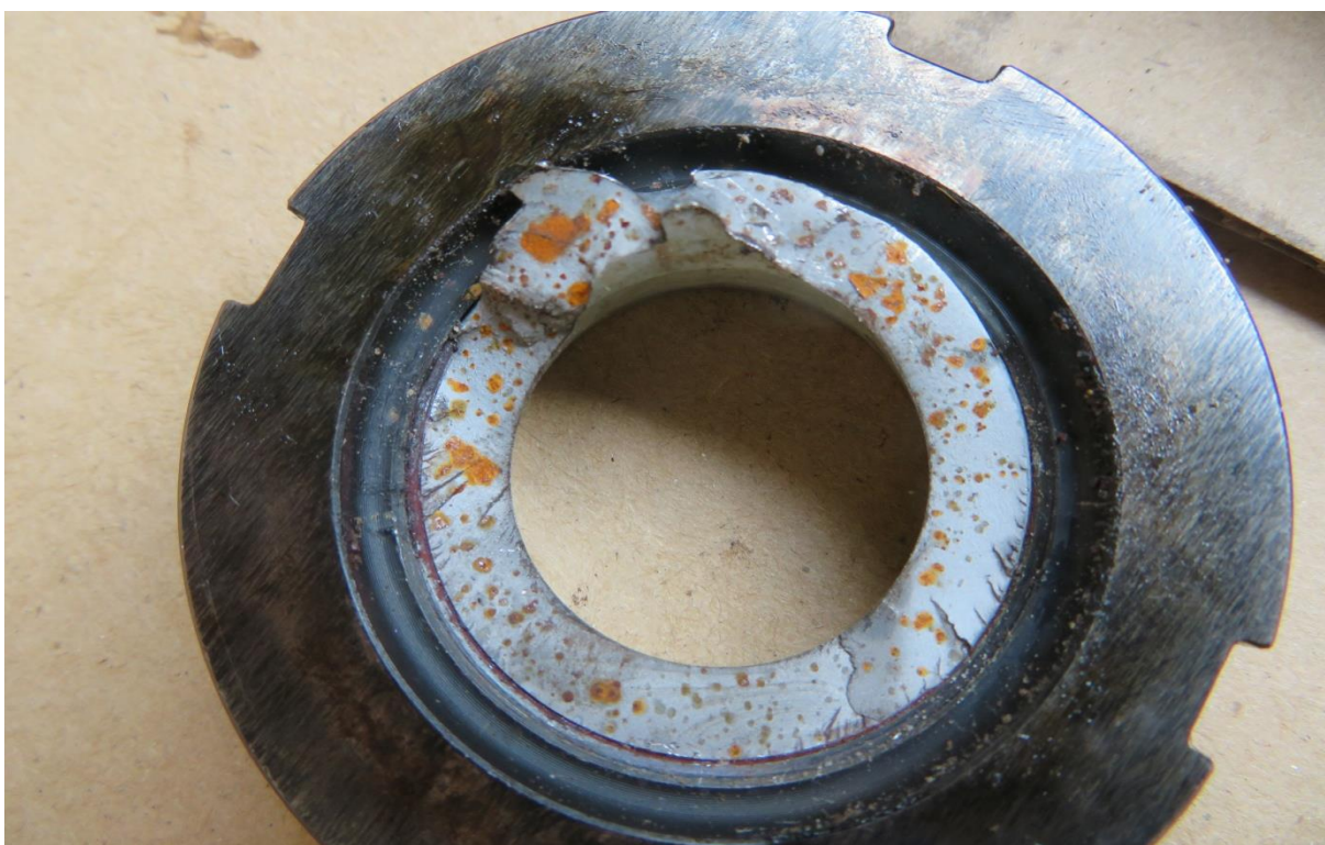
Rys. 6. Urwany uchwyt łopaty na obwodzie końcowej zwitki gwintu [źródło: PKBWL]
