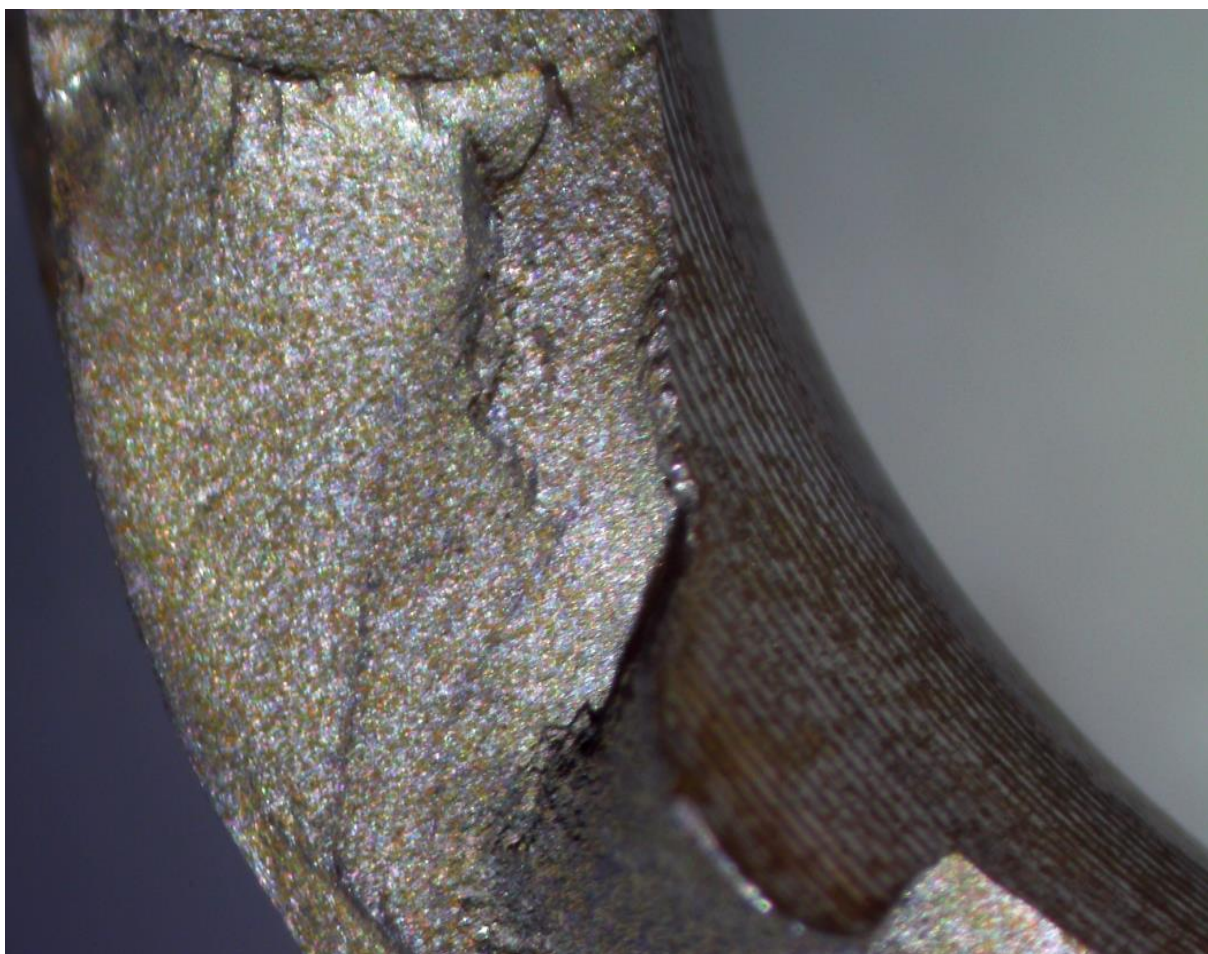
Rys. 11. Powierzchnia przełomu o charakterze zmęczeniowym [źródło: Politechnika Śląska]
