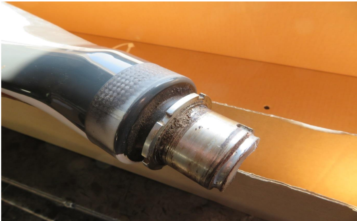
Rys. 5. Urwany uchwyt łopaty na ostatnim wcięciu gwintu [źródło: PKBWL]
