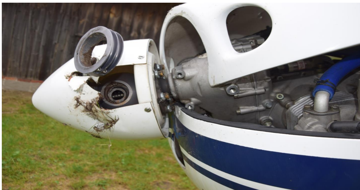
Rys. 4. Widoczne miejsce urwania łopaty śmigła w piasku [źródło: Policja]
