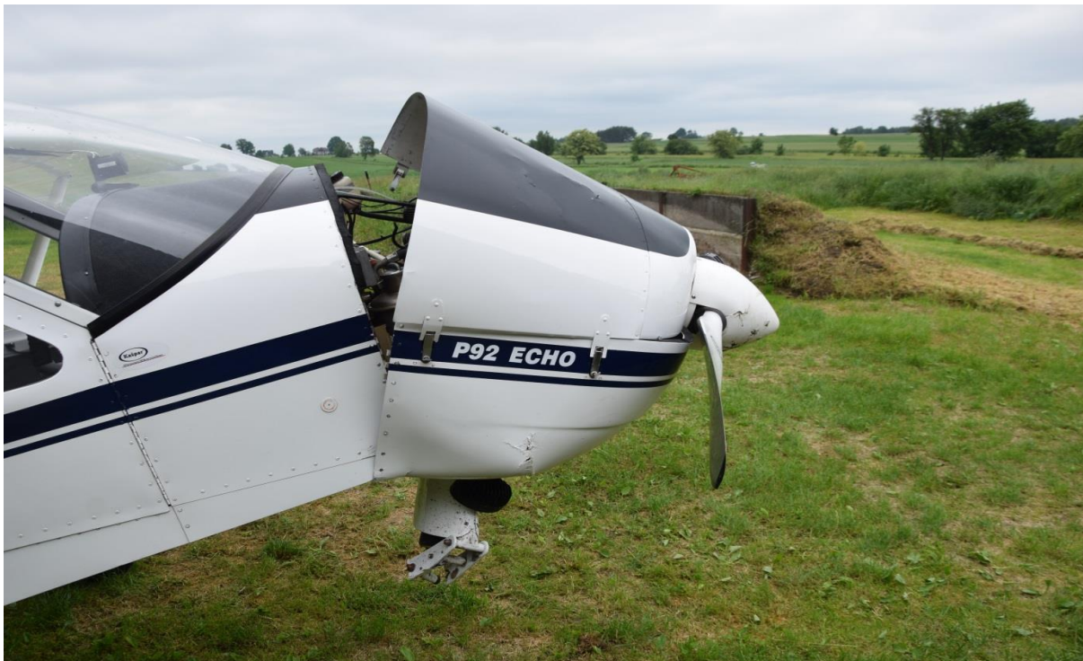
Rys. 3. Uszkodzenia przedniej części samolotu Tecnam P92 ECHO [źródło: Policja]
