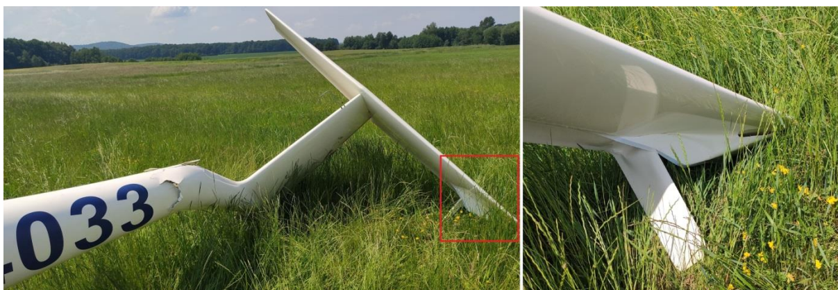
Rys. 2. Na zdjęciu widoczne są uszkodzenia szybowca [źródło: pilot szybowca]
