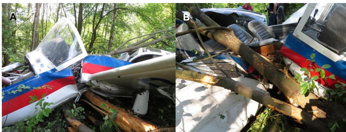
Rys. 2. Samolot SOCATA M.S. 893 E-D D-EGET widoczne uszkodzenia kabiny: A – widok z lewej strony, B – widok z prawej strony
