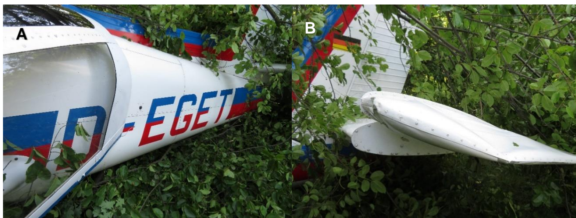
Rys. 4. Samolot SOCATA M.S. 893 E-D D-EGET stan po wypadku: A – ogon samolotu bez widocznych uszkodzeń z niemieckimi znakami rozpoznawczymi, B – usterzenie poziome i pionowe z widocznymi wgnieceniami
