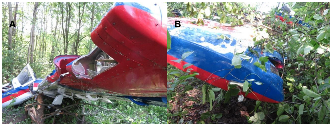
Rys. 3. Samolot SOCATA M.S. 893 E-D D-EGET widoczne uszkodzenia skrzydła: A – lewy płat, B – prawy płat
