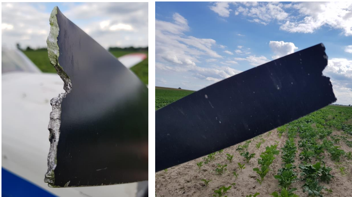
Rysunek 3. Uszkodzona łopata śmigła samolotu biorącego udział w zdarzeniu [Źródło: PKBWL]
