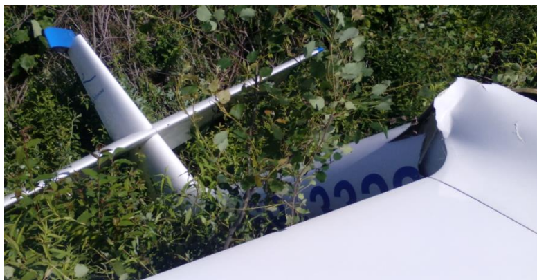
Rys. 2. Zdjęcie złamanego i rozwarstwowanego kadłuba szybowca [źródło: PKBWL]
