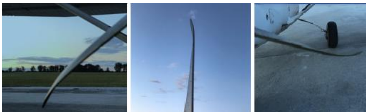
Rys. 1. Uszkodzone łopaty śmigła [źródło: użytkownik]
