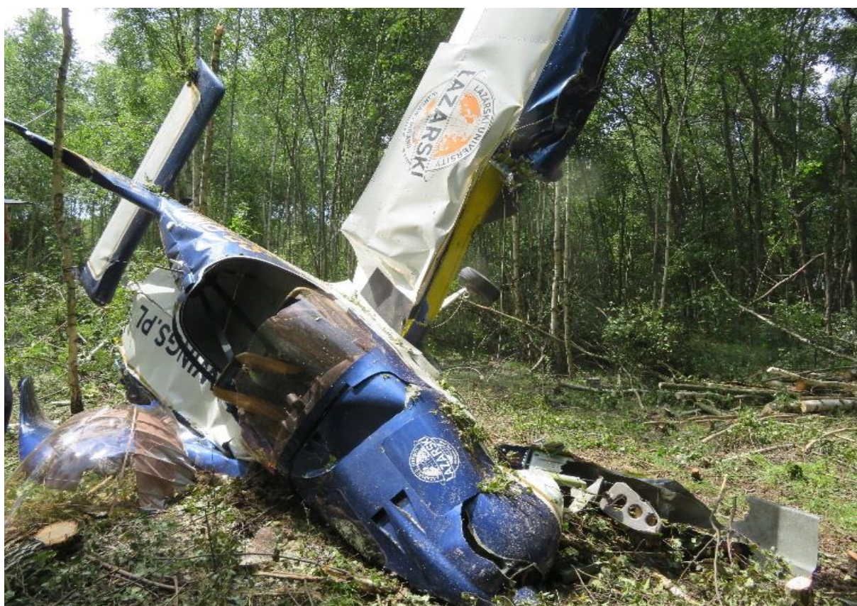
Rys. 7. Wrak samolotu AT3 R100 po zderzeniu z ziemią – widok od strony silnika [źródło: PKBWL]
