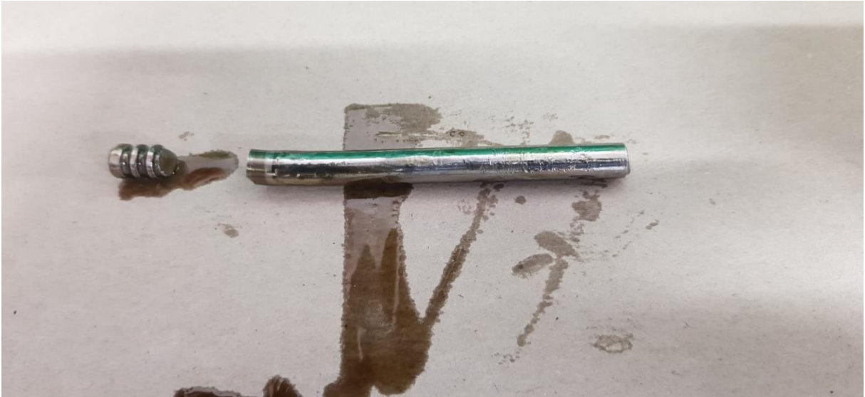
Rys. 1. Widok pękniętego trzonu zaworu wlotowego [źródło: Faston]
