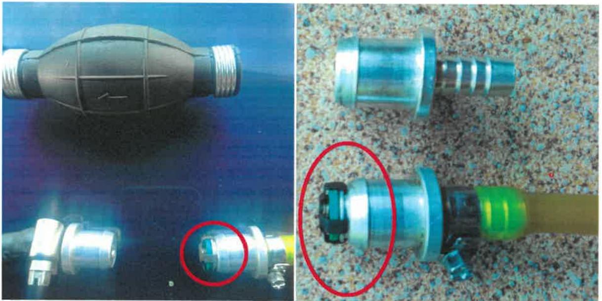
Rys. 5. Ręczna pompka paliwa i jej zawory zwrotne. Czerwonym kółkiem zaznaczono gumową membranę, która najprawdopodobniej była przyczyną nieprawidłowego działania zaworu zwrotnego [źródło: użytkownik motolotni]
