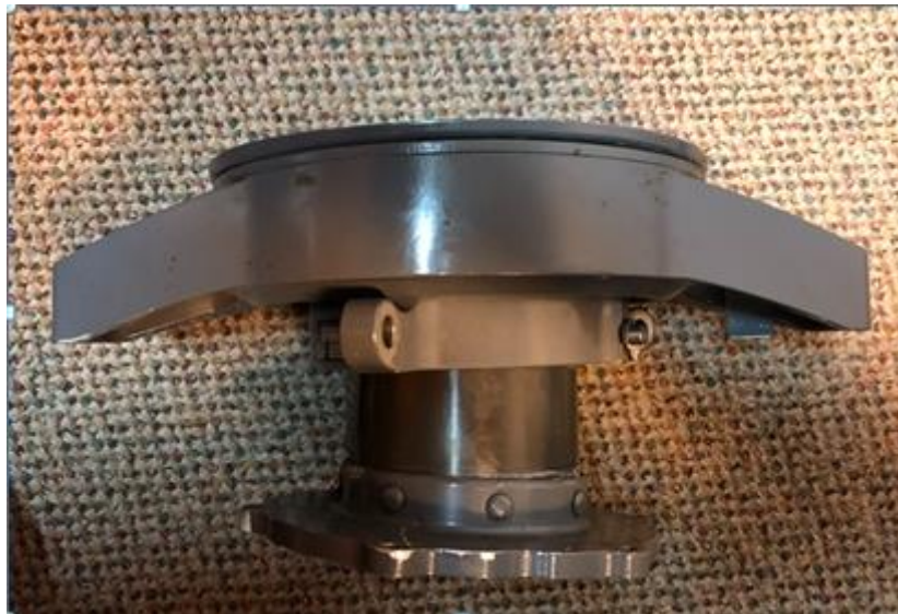
Rys. 26. Zdemontowany zespół tarczy sterującej wraz z tuleją przesuwną
