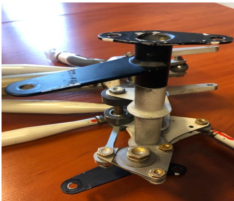
Rys. 25. Zdemontowany z wraku zespół tylnego wspornika układu sterowania
