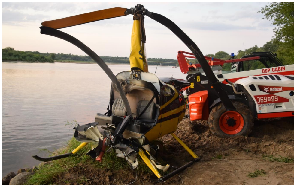
Rys. 3. Wrak śmigłowca po wydobyciu z wody
