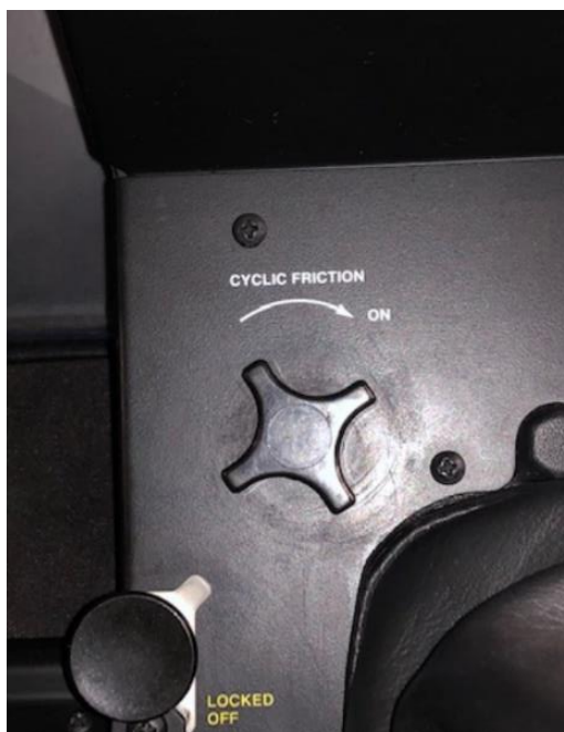
Rys. 11. Pokręćło regulacji tarcieć drążka sterowania okresowego
