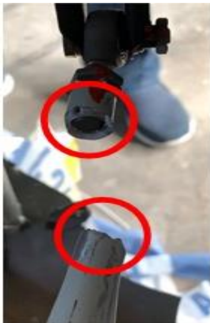
Rys. 22. Złamany przy zderzeniu z wodą popychacz sterowania dźwigni skoku – mocy P/N: C121-19
