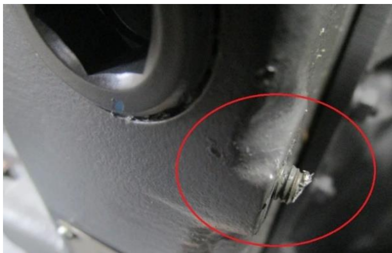
Rys. 18. Uszkodzenie zewnętrzne silnika
