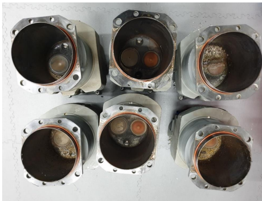
Rys. 20. Zdemontowane cylindry ze śladami korozji spowodowanej długotrwałą obecnością wody po zdarzeniu
