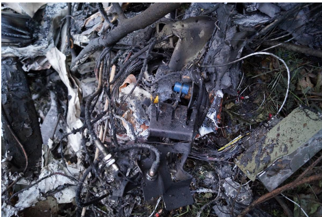
Rys. 10 Elementy sterowania silnikiem odnalezione na miejscu zdarzenia (źródło PKBWL)
