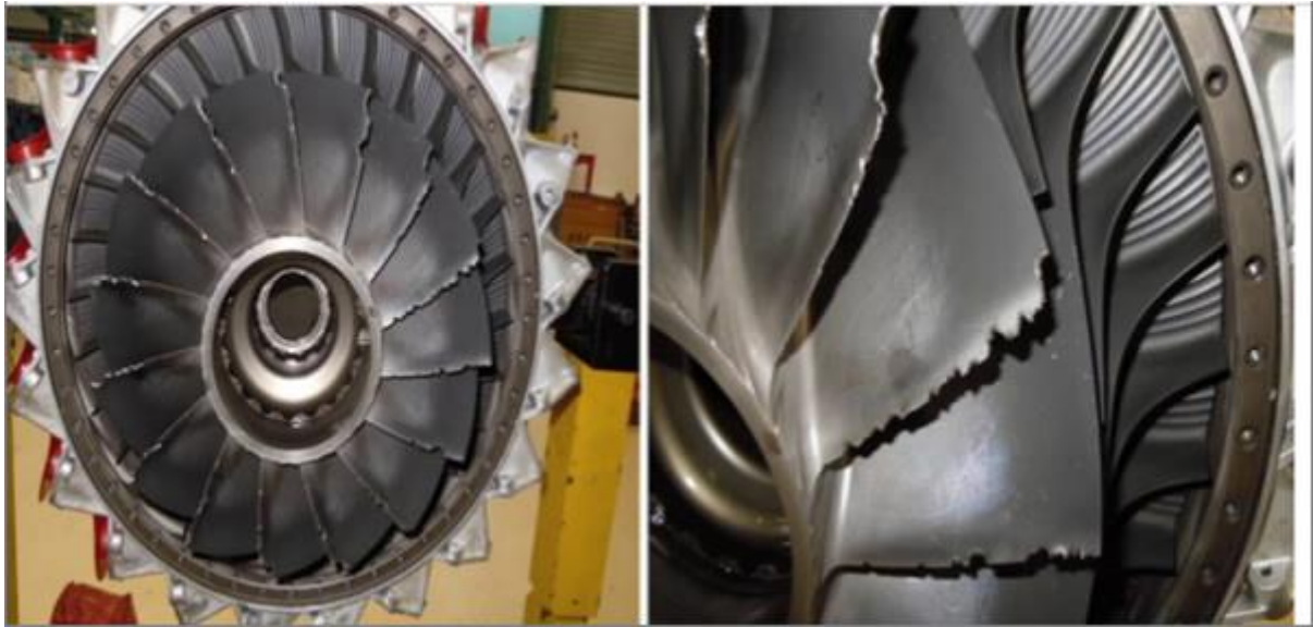
Rys. 1. Uszkodzenia łopatek sprężarki odśrodkowej niskiego ciśnienia [źródło: StandardAero]
