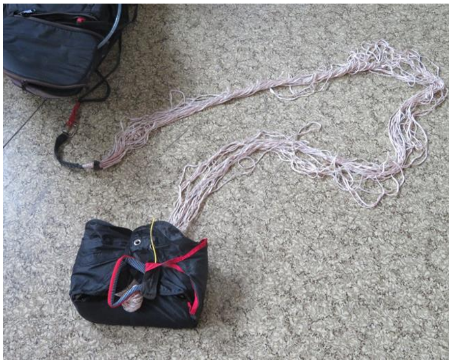
Rys. 7. Spadochron ratunkowy. Widoczne częściowo wyplecione linki [źródło: PKBWL]
