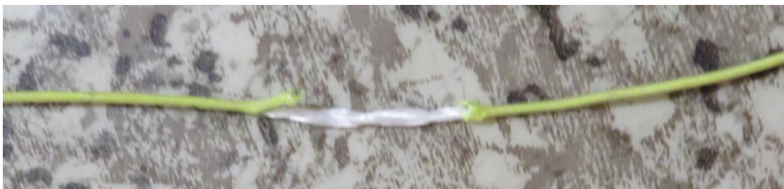
Rys. 3. Uszkodzony oplot lewej linki sterowniczej [źródło: PKBWL]
