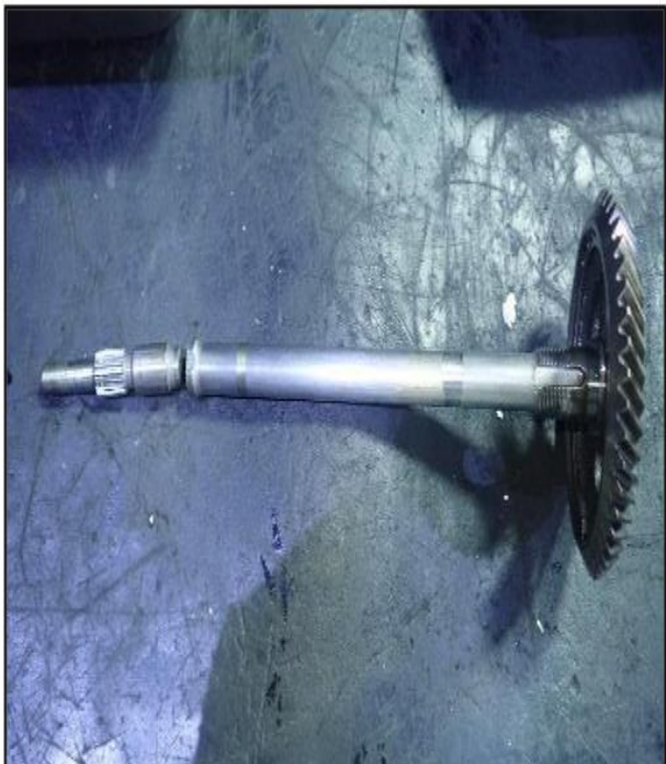
Rys. 2. Widok pękniętego wałka i powierzchni przełomu [źródło: P&W]
