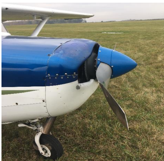
Rys. 2. Widoczne uszkodzone (wygięte) śmigło samolotu SP-FZY [źródło: PKBWL]
