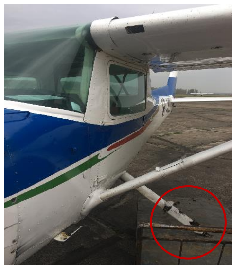
Rys. 3. Uszkodzona lewa goleń samolotu SP-AKW [źródło: PKBWL]
