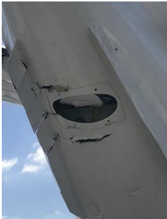
Rys. 3 . Uszkodzenia samolotu SAAB SF340A w części ogonowej [źródło: Port Lotniczy Gdańsk]
