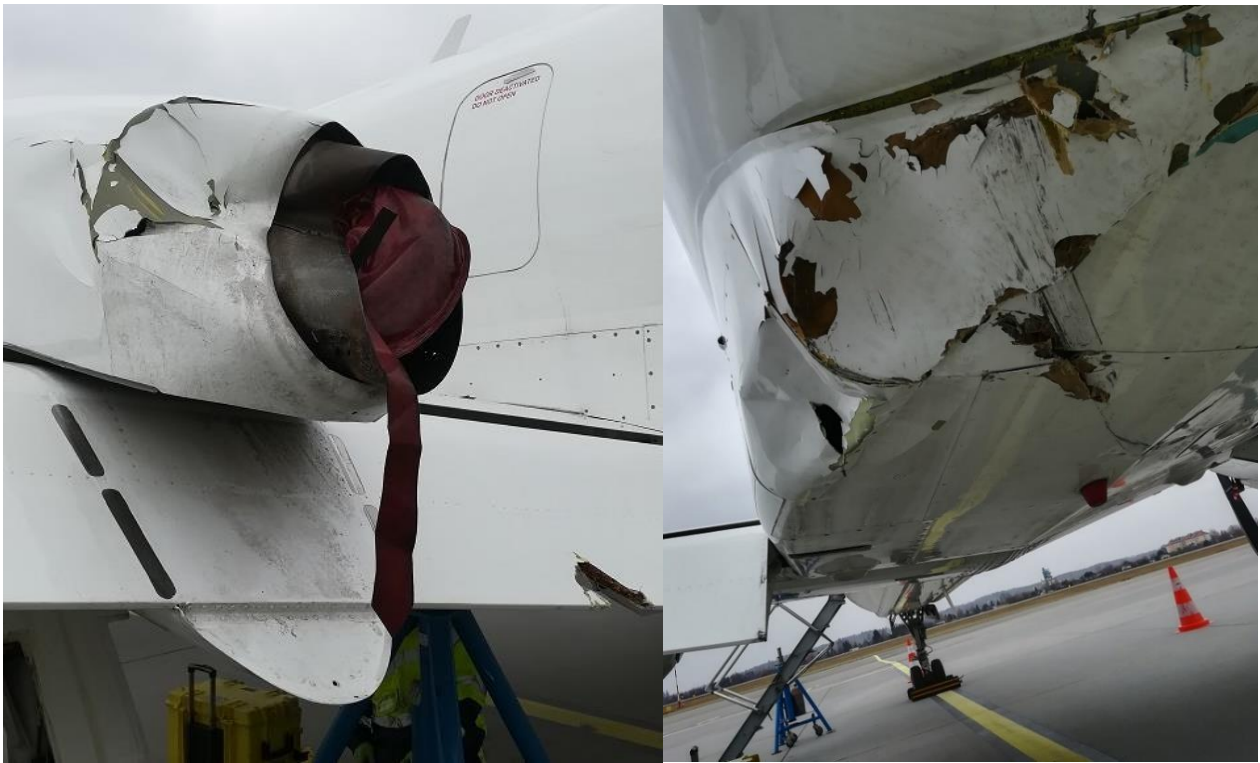
Rys. 4. Samolot SAAB SF340A: uszkodzenia lewego silnika oraz klapy lewego skrzydła (zdjęcie po lewej) i uszkodzenia dolnej części kadłuba (zdjęcie po prawej) [źródło: Port Lotniczy Gdańsk]
