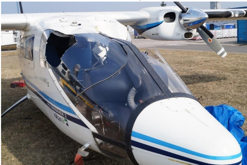
Rys. 1. Samolot P.68 "OBSERVER 2": uszkodzone oszklenie kabiny (zdjęcie po lewej) i uszkodzona łopata prawego śmigła silnika (zdjęcie po prawej) [źródło: PKBWL]
