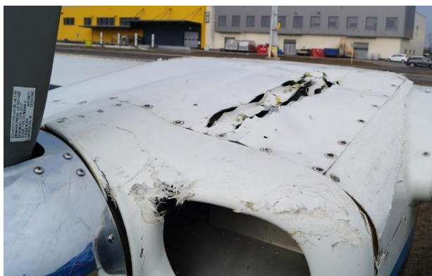
Rys. 2. Samolot P.68 "OBSERVER 2": uszkodzona osłona prawego silnika (zdjęcie po lewej) i uszkodzone lewe skrzydło (zdjęcie po prawej) [źródło: PKBWL]
