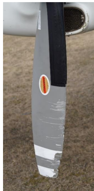
Rys. 1. Samolot P.68 "OBSERVER 2": uszkodzone oszklenie kabiny (zdjęcie po lewej) i uszkodzona łopata prawego śmigła silnika (zdjęcie po prawej) [źródło: PKBWL]
