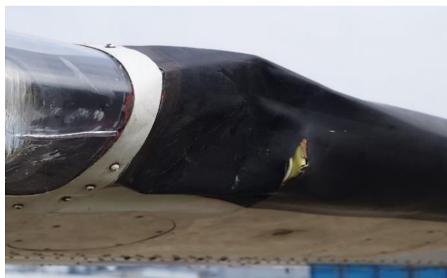
Rys. 2. Samolot P.68 "OBSERVER 2": uszkodzona osłona prawego silnika (zdjęcie po lewej) i uszkodzone lewe skrzydło (zdjęcie po prawej) [źródło: PKBWL]
