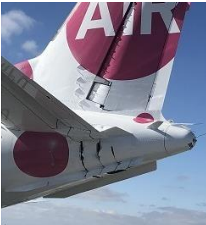
Rys. 3 . Uszkodzenia samolotu SAAB SF340A w części ogonowej [źródło: Port Lotniczy Gdańsk]
