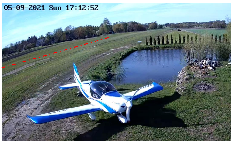
Rys. 7 Chwila tuż przed uderzeniem samolotu w budynek: widać wychyloną w górę lewą lotkę i niewychylony (w pozycji neutralnej) ster kierunku [źródło: PKBWL]
