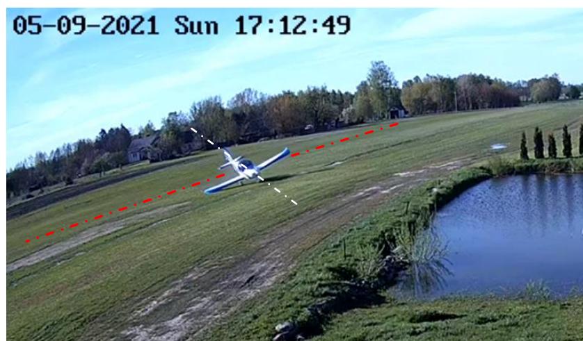
Rys. 6 Podparcie się skrzydłem o murawę lądowiska, po utracie kierunku. Przerywaną czerwoną linią zaznaczono właściwy, ale nie zachowany kierunek rozbiegu [źródło: PKBWL]
