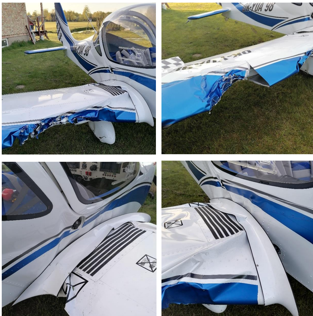
Rys. 2 Uszkodzenia samolotu w wyniku uderzenia w budynek [źródło: PKBWL]
