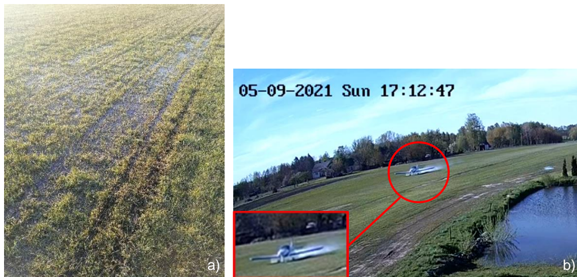
Rys. 5 a) Zastoisko wody na drodze startowej i widoczne ślady po kołach samolotów w dniu zdarzenia; b) Widok startującego samolotu. W powiększonym kadrze zwraca uwagę pióropusz wody za samolotem, powstały podczas przejazdu przez kałużę [źródło: PKBWL]
