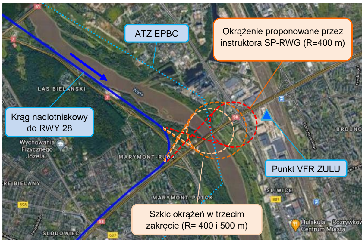
Rys. 5 Szkic miejsc wykonywania okrążeń w celu zachowania separacji pomiędzy statkami powietrznymi w kręgu nadlotniskowym do RWY 28 lotniska EPBC [źródło: Internet, Google Earth, PAŻP]
