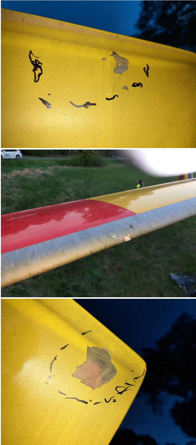
Rys. 1 Uszkodzenia łopat śmigłowca SP-HXP [źródło: LPR]
