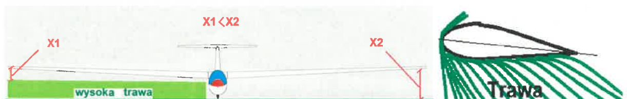
Rys. 6. Po lewej stronie pokazano jak zmienia się odległość skrzydła szybowca od powierzchni lotniska przy niewykoszonej trawie. Po prawej stronie pokazano jak trawa zawija się na krawędzi natarcia skrzydła [źródło: PKBWL]
