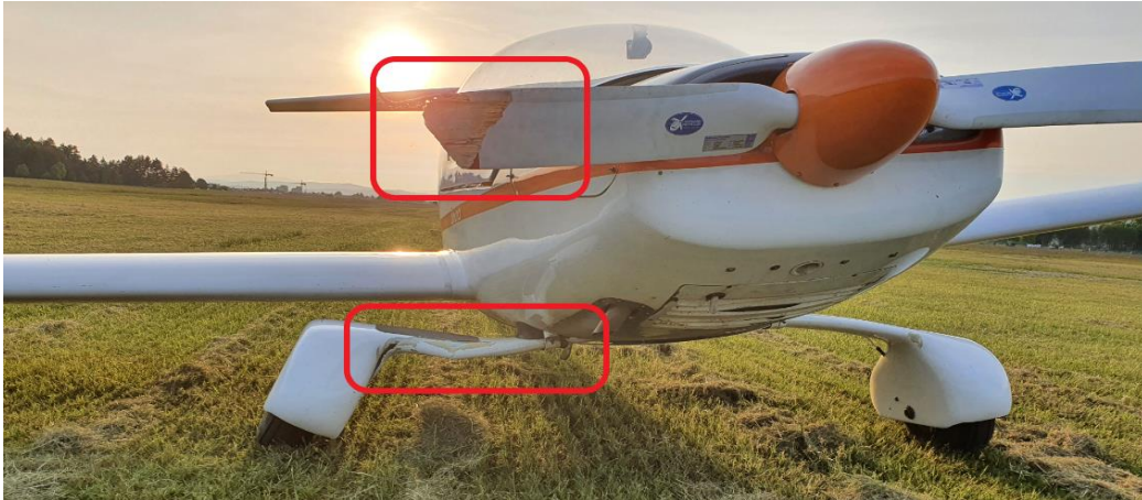
Rys. 1. Złamana łopata śmigła i uszkodzona goleń prawego podwozia [źródło: Użytkownik]
