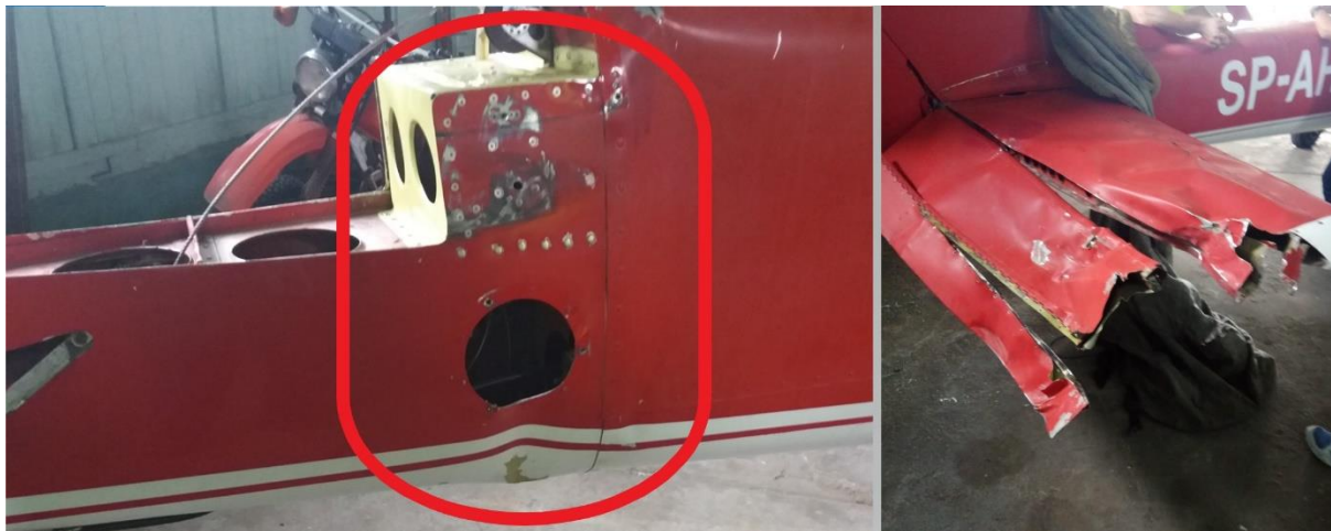
Rys. 3. Uszkodzenia samolotu Cessna 150 [źródło: PKBWL]
