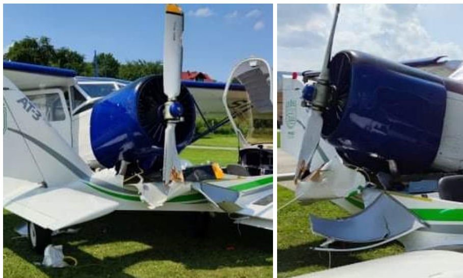
Rys. 5 Uszkodzenia kadłuba AT-3 oraz zespołu napędowego Jak-12M [źródło: Użytkownik]
