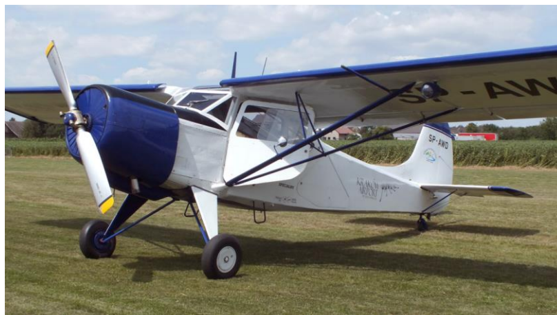
Rys. 4 Samolot Jak-12M. Zwraca uwagę wysokie umiejscowienie maski silnika, ponad poziomem oczu pilota [źródło: Internet]
