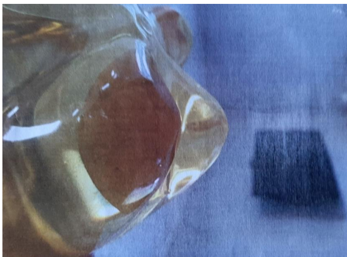
Rys. 3. Substancja o konsystencji parafiny zlokalizowana w odstojniku paliwa po zlianiu do butelki [źródło: użytkownik]
