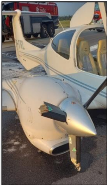
Rys. 4 i 5. Samolot SP-TRL ze zniszczonymi łopatami śmigieł prawego i lewego silnika. [źródło: PKBWL]
