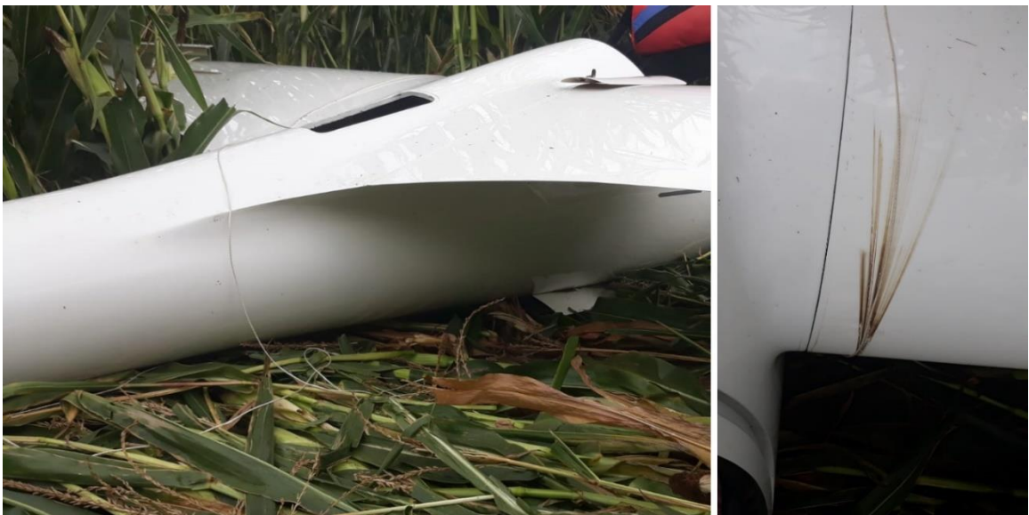
Rys. 2. Na ilustracji z lewej strony pokazano linę holowniczą zarzuconą na szybowiec. Na ilustracji z prawej pokazano ślady pozostawione przez linę na krawędzi natarcia lewego skrzydła. [źródło: Aeroklub Leszczyński]
