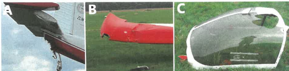
Rys. 7. Uszkodzony ogon, końcówka prawego skrzydła i owiewka kabiny samolotu [źródło: PKBWL]
