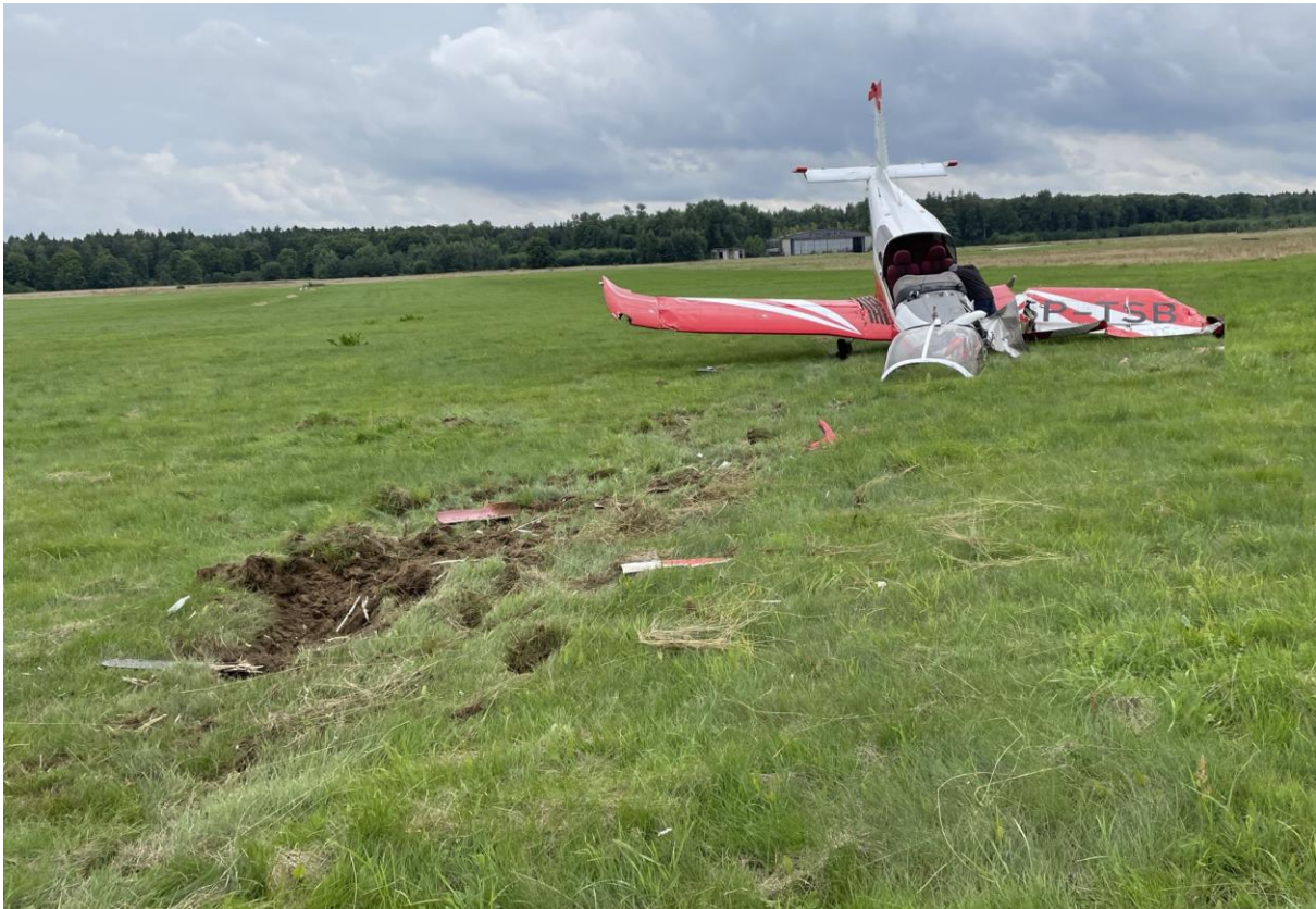
Rys 3. Widok na samolot po zderzeniu. Widoczne miejsce, w którym przednia część kadłuba z silnikiem zderzyły się z ziemią [źródło: PKBWL]
