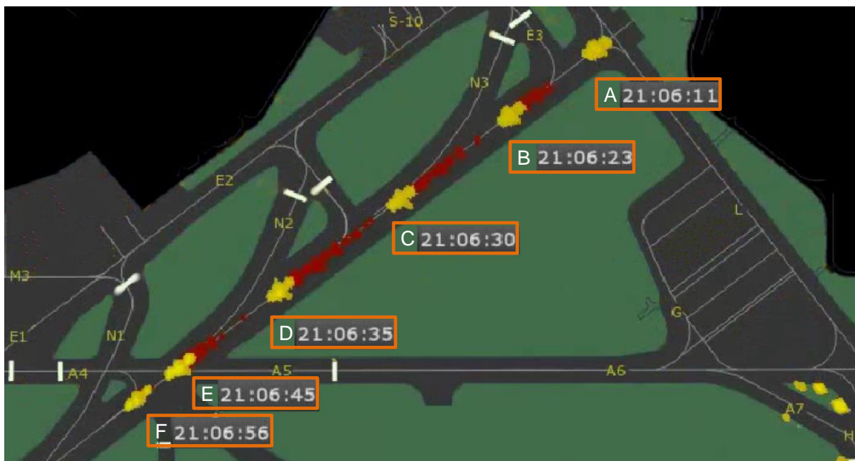
Rys. 2. Przerwany start samolotu FDB1830: A – rozpoczęcie rozbiegu, B – wydanie polecenia przerwania startu, C – potwierdzenie przyjęcia polecenia przerwania startu, D i E – zmniejszanie prędkości, F - zatrzymanie [źródło: PAŻP, PKBWL]
