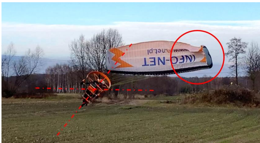
Rys. 8. Deformacja skrzydła w miejscu wszycia linek sekcji D [źródło: materiał filmowy użytkownika / PKBWL]
