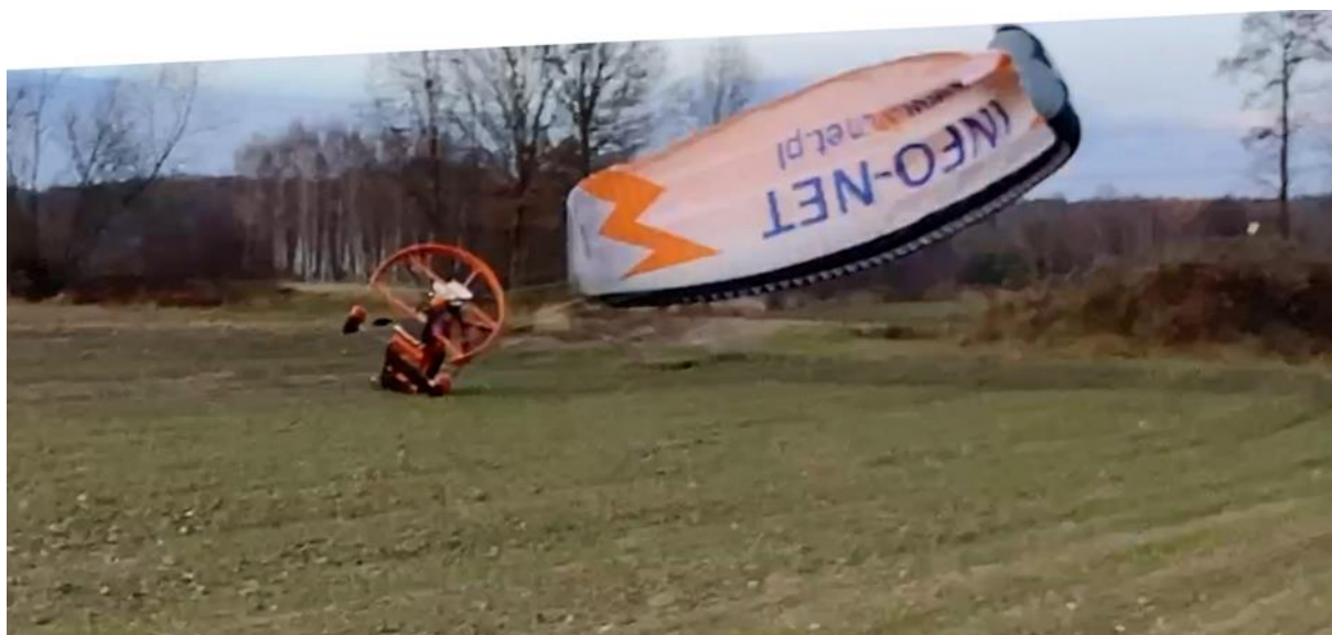
Rys. 7. Zderzenie wózka motoparalotni z ziemią [źródło: materiał filmowy użytkownika / PKBWL]
