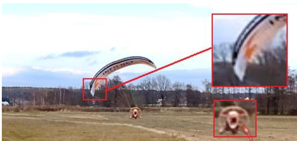
Rys. 4. Początkowa faza rozbiegu i ułożenia skrzydła w stosunku do wózka motoparalotni. Czerwoną strzałką pokazano lewą rękę pilota [źródło: materiał filmowy użytkownika / PKBWL]
