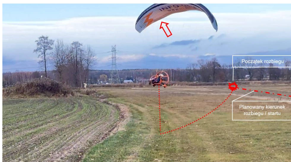
Rys. 5. Parolotnia po starcie i rzut trajektorii wlotu na płaszczyznę ziemi. Widać zaburzenie kształtu skrzydła (czerwona strzałka) [źródło: materiał filmowy użytkownika / PKBWL]
