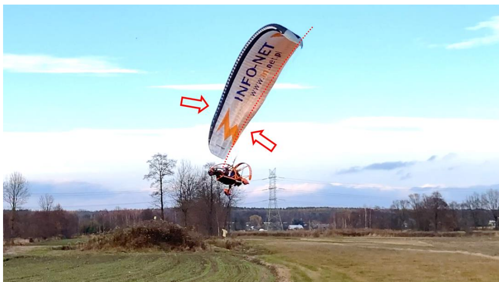
Rys. 6. Strome wznoszenie i postępujący, niezamierzony przez pilota zakręt motoparalotni. Utrzymuje się zaburzenie geometrii skrzydła. Linia kropkowaną schematycznie zaznaczono prawidłowy kształt krawędzi spływu skrzydła [źródło: materiał filmowy użytkownika / PKBWL]
