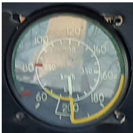
Rys. 6 Prędkościomierz zabudowany w samolocie SP-STYL (pole zielone do V = 160 km/godz., pole żółte do V=230 km/godz., znacznik czerwony V_{NE} \cong 250 km/godz.) oraz tabela oznaczeń prędkościomierza wg Instrukcji Użytkowania w Locie [źródło: PKBWL]
