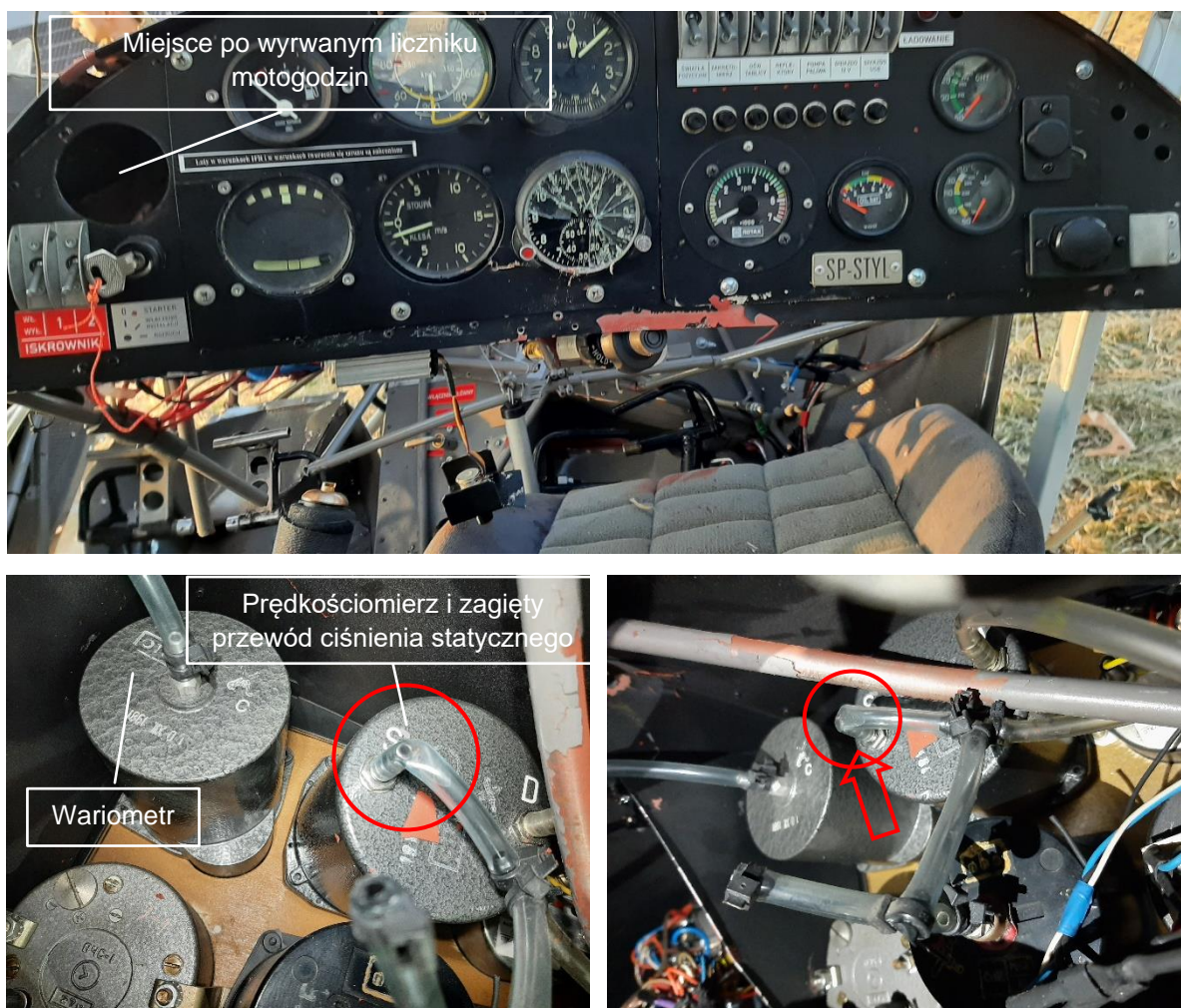
Rys. 5 Awionika samolotu SP-STYL oraz podłączenie przewodu ciśnienia statycznego doprędkościomierza [źródło: PKBWL]
