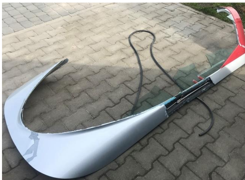
Rys. 3 Odnaleziony fragment ramy osłony kabiny [źródło: PKBWL]
