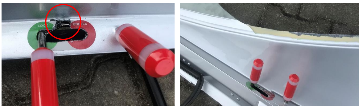
Rys. 9 Suwaki blokowania osłony kabiny: tylny (po lewej) oraz przedni (po prawej) [źródło: PKBWL]
