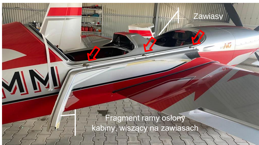
Rys. 2 Kabina samolotu wraz z fragmentem wyłamanej ramy osłony [źródło: PKBWL]
