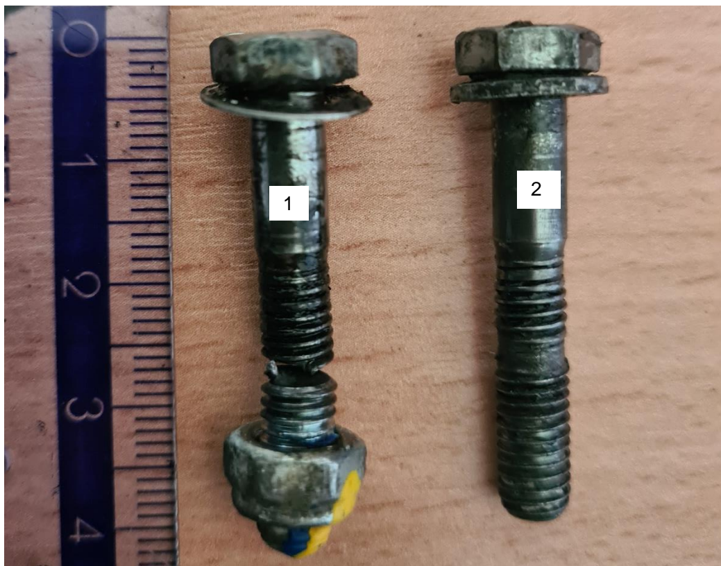
Rys. 1. Widok urwanej (1) i uszkodzonej (2) śruby mocowania zawiasów poziomego usterzenia płytowego [źródło: PKBWL]
