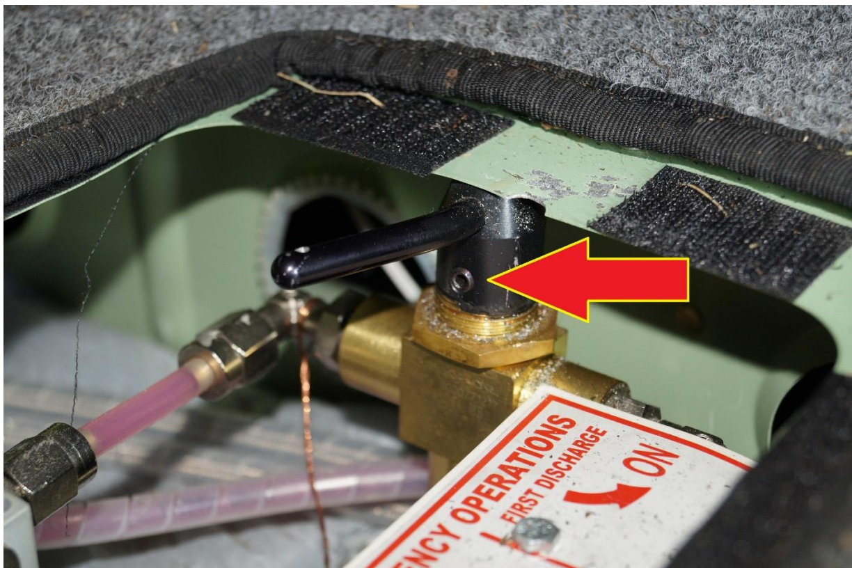
Rys. 11. Połączenie dźwigni z prawym zaworem układu awaryjnego wypuszczenia podwozia. Strzałką oznaczono śrubę robaczkową, przeciwdziałającą swobodnemu obrotowi dźwigni na wałku zaworu [źródło: PKBWL]
