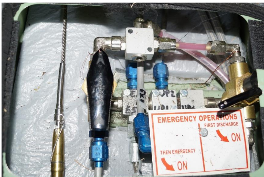
Rys. 10. Zawory układu awaryjnego wypuszczania podwozia w samolocie Tecnam P2006T [źródło: PKBWL]
