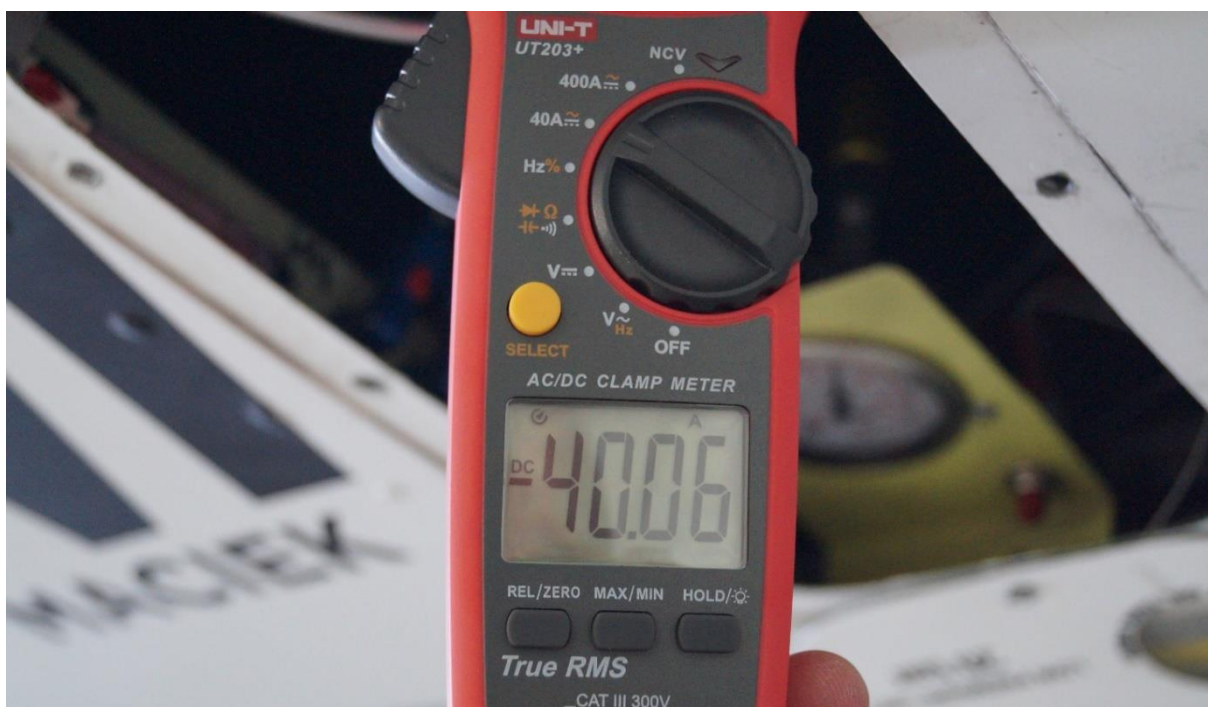
Rys. 5. Wynik pomiaru wartości prądu płynącego przez przełączniki elektryczne układu wypuszczania i chowania podwozia sfotografowany podczas próby [źródło: PKBWL]
