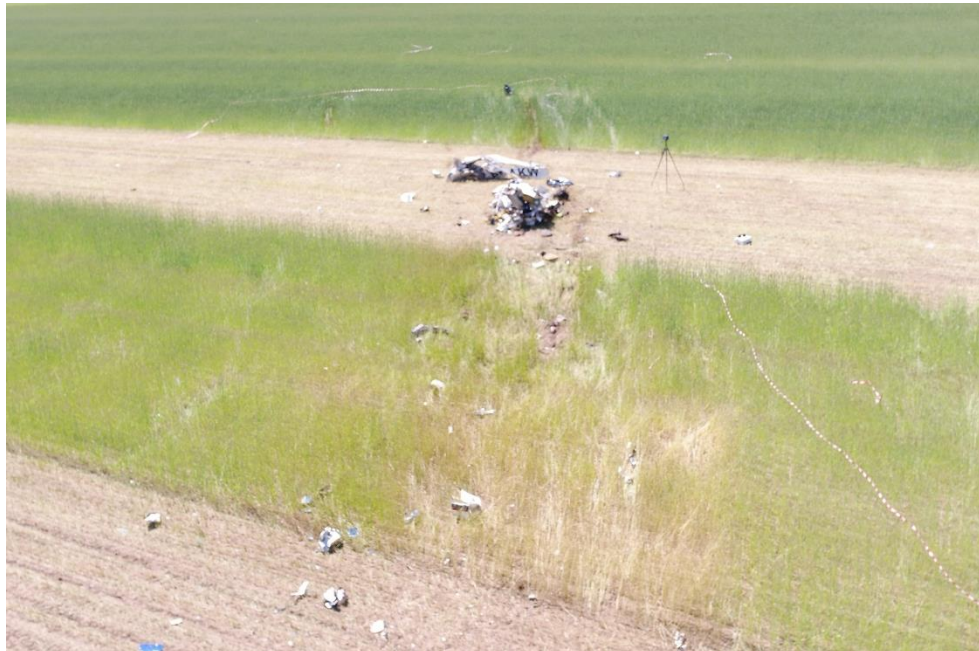
Rys. 4 Ślad i szczątki samolotu po zderzeniu z polem [źródło: Policja]
