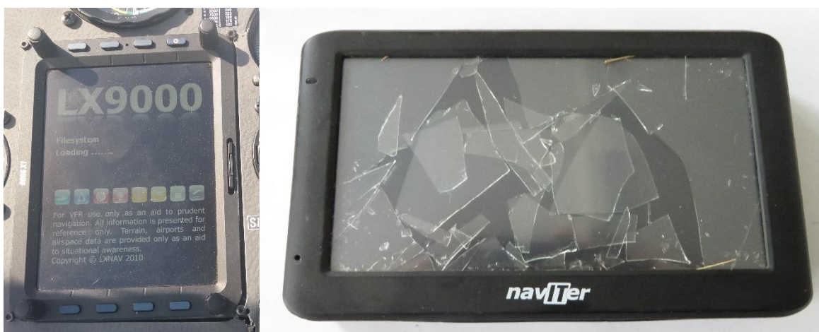
Rys. 6. Rejestratory lotu. Po prawej stronie uszkodzony rejestrator Naviter Oudie IGC [źródło: PKBWL]
