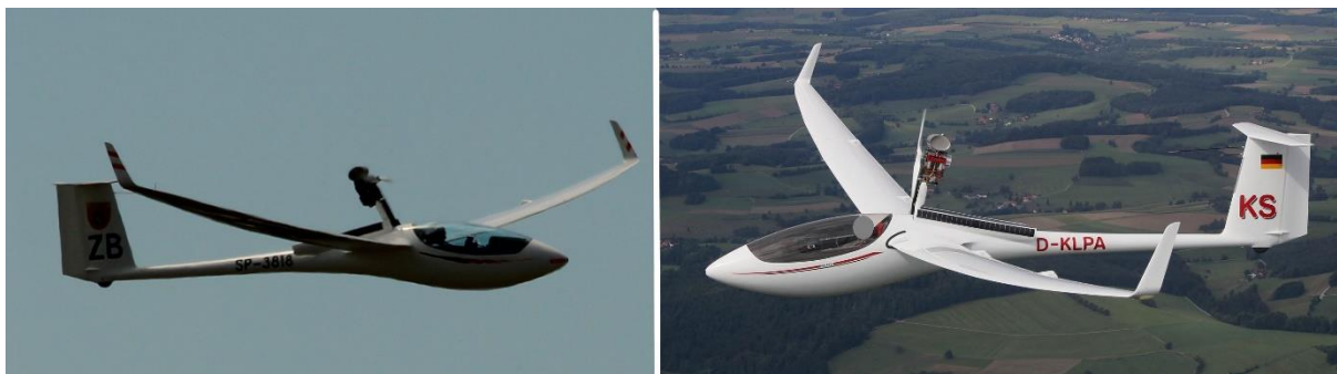
Rys. 12. Położenie masztu w locie: po lewej – w szybowcu, który uległ wypadkowi, po prawej – prawidłowe położenie [źródło: Dariusz Deptuła, Internet]
