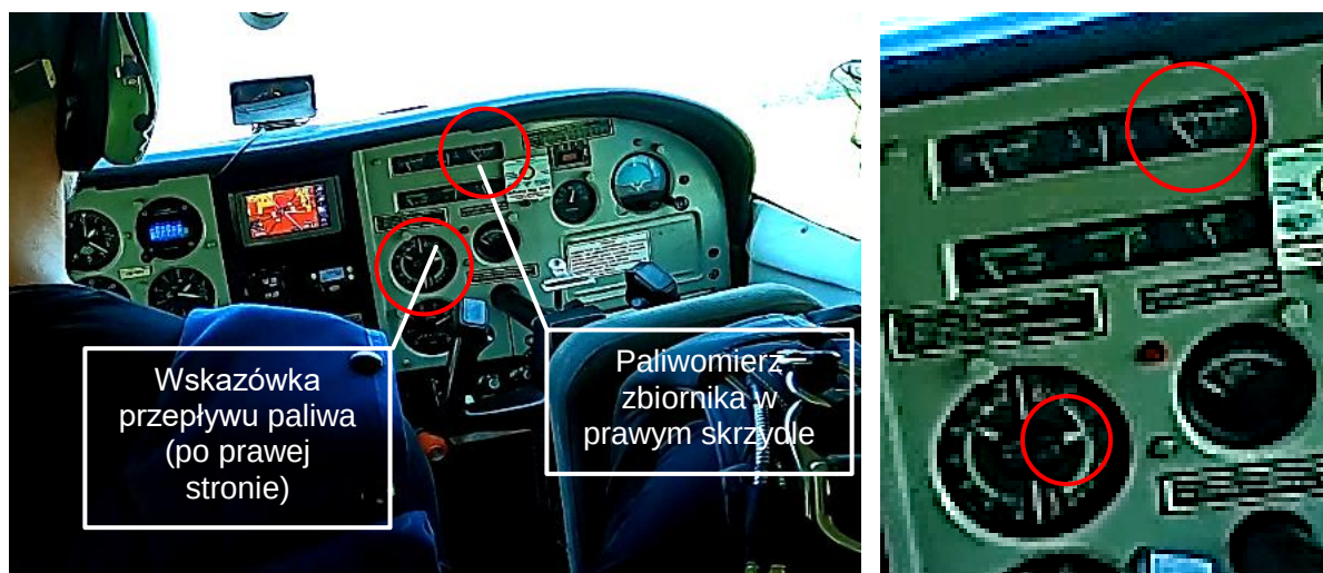
Rys. 12. Widok na tablicę przyrządów w 7 s. po rozpoczęciu rozbiegu. Na rysunku po prawej stronie pokazano powiększenie fragmentu tablicy i zaznaczono paliwomierz oraz przepływomierz [źródło: materiał video z kamery jednego ze skoczków]
