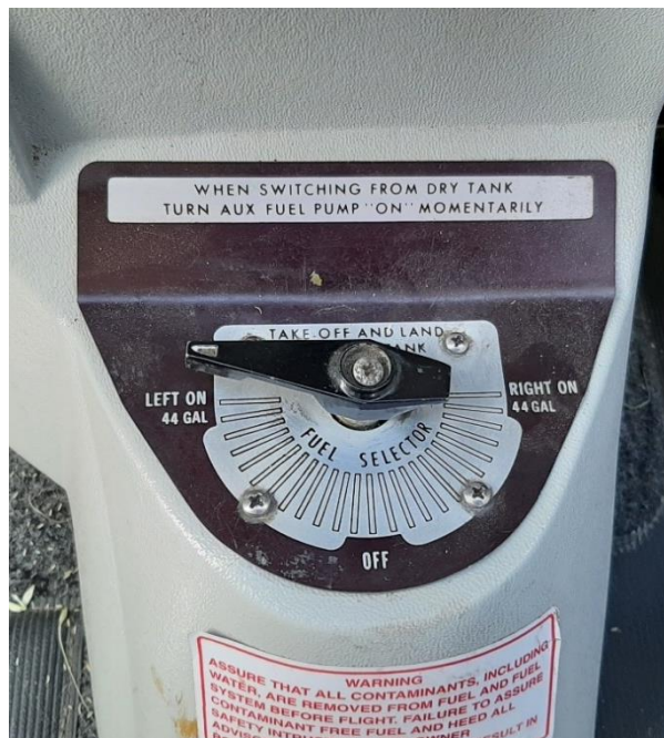
Rys. 9. Widok zaworu paliwowego w kabinie – pokrętło zaworu (w kolorze czarnym) steruje dopływem paliwa ze zbiorników do przedziału silnikowego [źródło: PKBWL]
