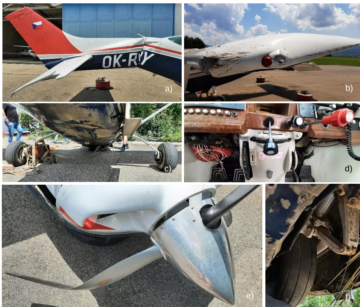
Rys. 3. Uszkodzenia samolotu: a) przełamany kadłub, b) uszkodzona końcówka lewego skrzydła, c) uszkodzenia spodu kadłuba oraz goleni podwozia, d) podgięta dźwignia przepustnicy, e) wygięte łopaty śmigła, f) wyłamane podwozie przednie, wciśnięte do przedziału silnikowego [źródło: PKBWL]
