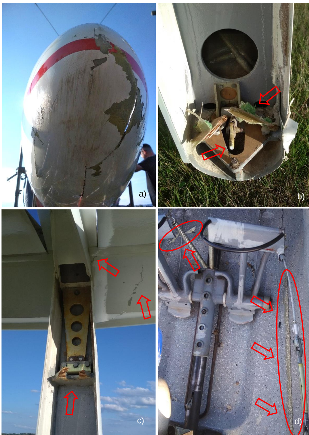
Rys. 3. Uszkodzenia szybowca: a) spękana skorupa kadłuba w obrębie kabiny pilota, b) wyrwany ster kierunku, zniszczony dolny wspornik zawieszenia steru kierunku oraz zerwany napęd steru wysokości, c) zniszczone górne zawieszenie steru kierunku, brak steru, pęknięcia dolnej skorupy statecznika poziomego, d) odklejona podłoga kabiny [źródło: PKBWL]
