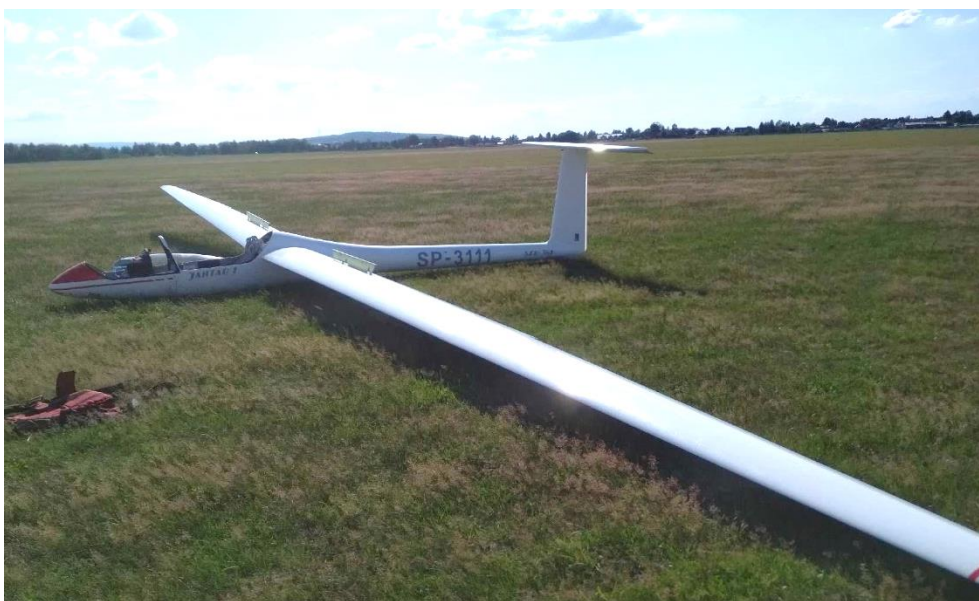
Rys. 9. Szybowiec po zdarzeniu. Widoczny brak wysuniętego podwozia, brak stałej części osłony kabiny oraz steru kierunku [źródło: PKBWL]
