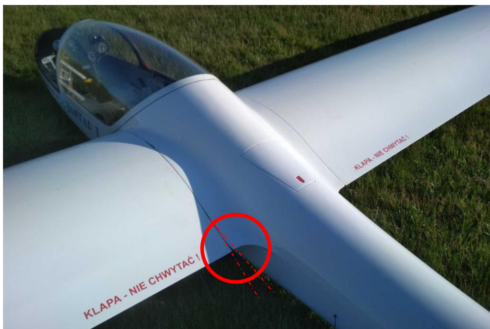
Rys. 8. Konfiguracja klap szybowca po lądowaniu – widoczne niewielkie wychylenie w dół [źródło: PKBWL]
