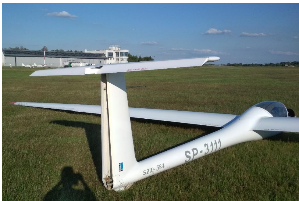
Rys. 2. Szybowiec SP-3111 po twardym lądowaniu, widoczny jest brak podwozia i uszkodzenia ogona (na drugim planie zabudowania lotniskowe) [źródło: PKBWL]
