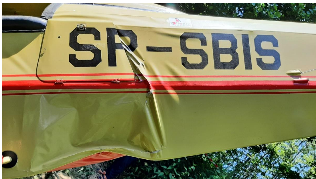
Rys. 5. Przełamanie kadłuba za kabiną pilotów [źródło: PKBWL]
