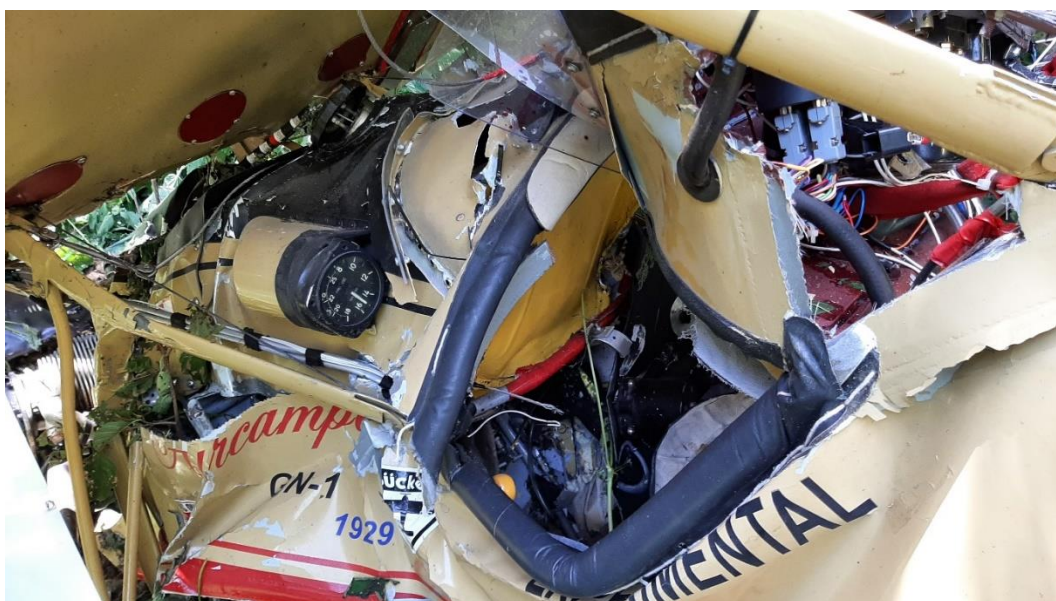
Rys. 4. Zmiażdżona pierwsza kabina – widok w kierunku lotu [źródło: PKBWL]
