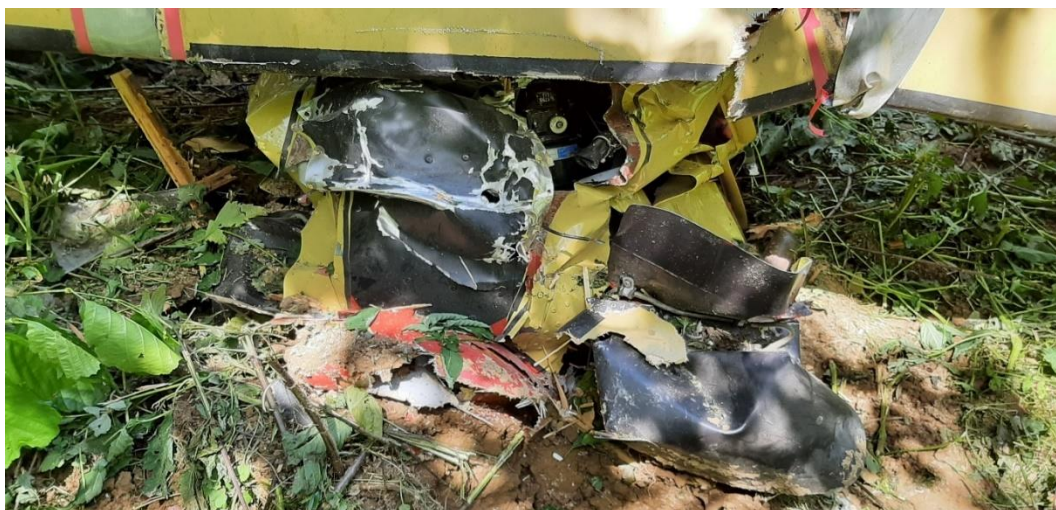
Rys. 10. Zagłębiony w ziemi nos samolotu wraz z silnikiem [źródło: PKBWL]
