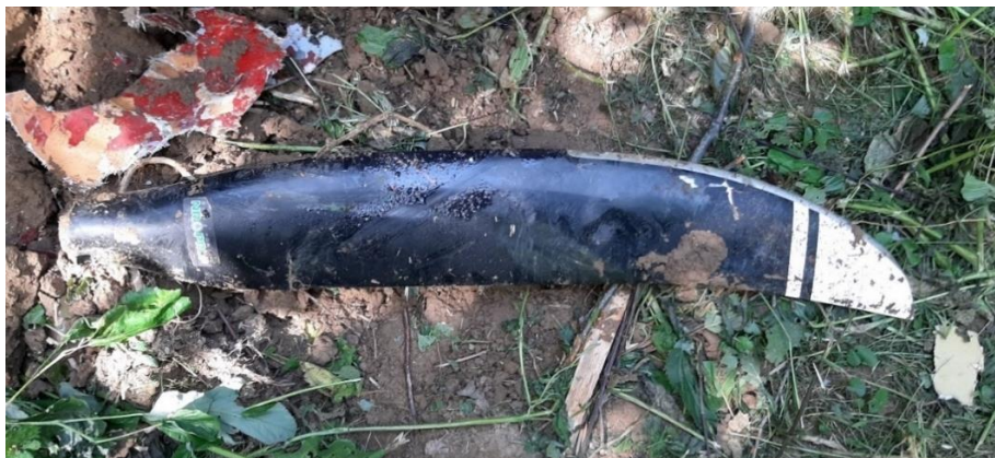
Rys. 9. Wylamana łopata śmigła. Brak uszkodzeń końcówki oraz krawędzi natarcia prowadzi do wniosku, że śmigło podczas zderzenia nie obracało się. [źródło: PKBWL]
