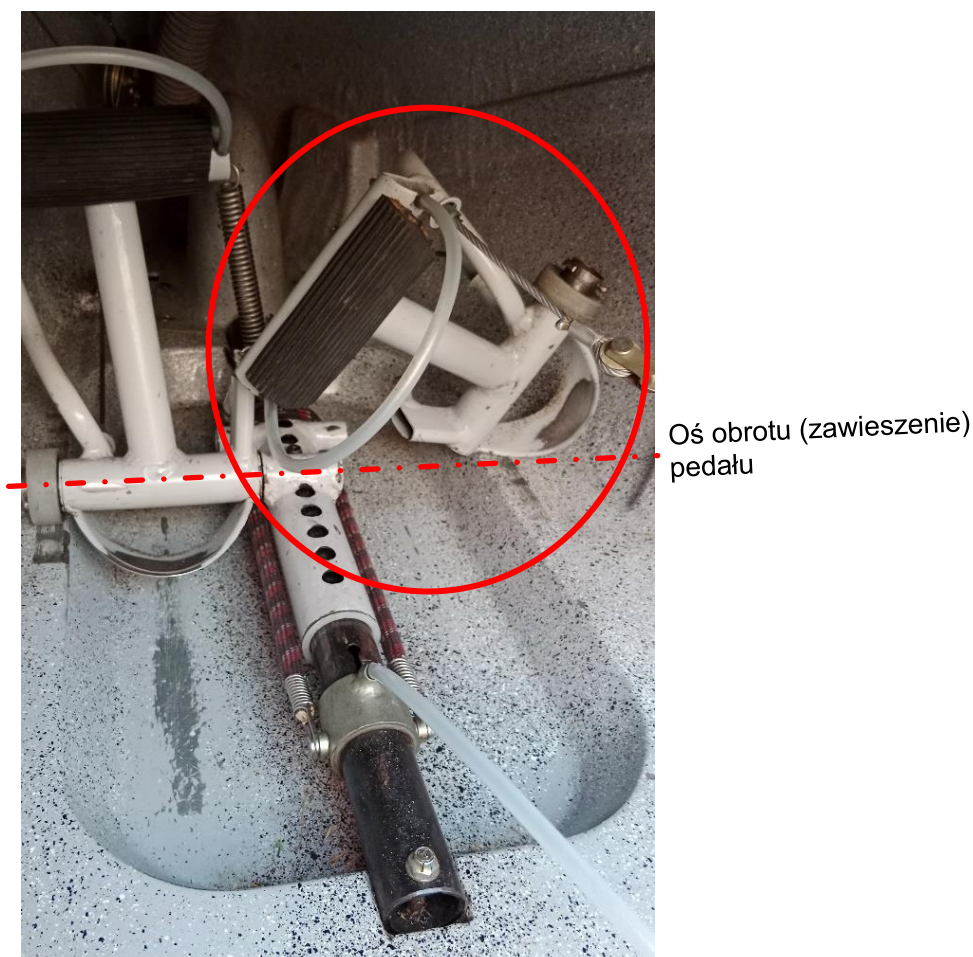
Rys. 1. Uszkodzony pedał steru kierunku w przedniej kabine szybowca SP-3288 [źródło: PKBWL]
