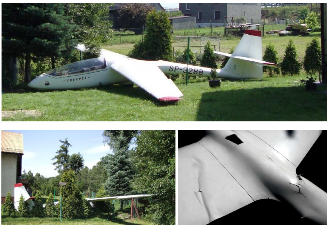
Rys. 7. Wypadek i widoczne uszkodzenia strukturalne szybowca w 2009 r. [źródło: archiwum PKBWL, raport nr 556/09]
