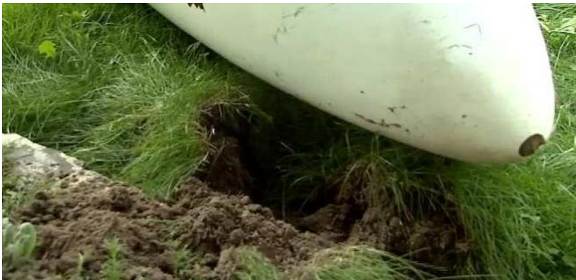
Rys. 8. Wyrwa w ziemi spowodowana zderzeniem się nosa kadłuba w wypadku z 2009 r. [źródło: archiwum PKBWL, raport nr 556/09]
